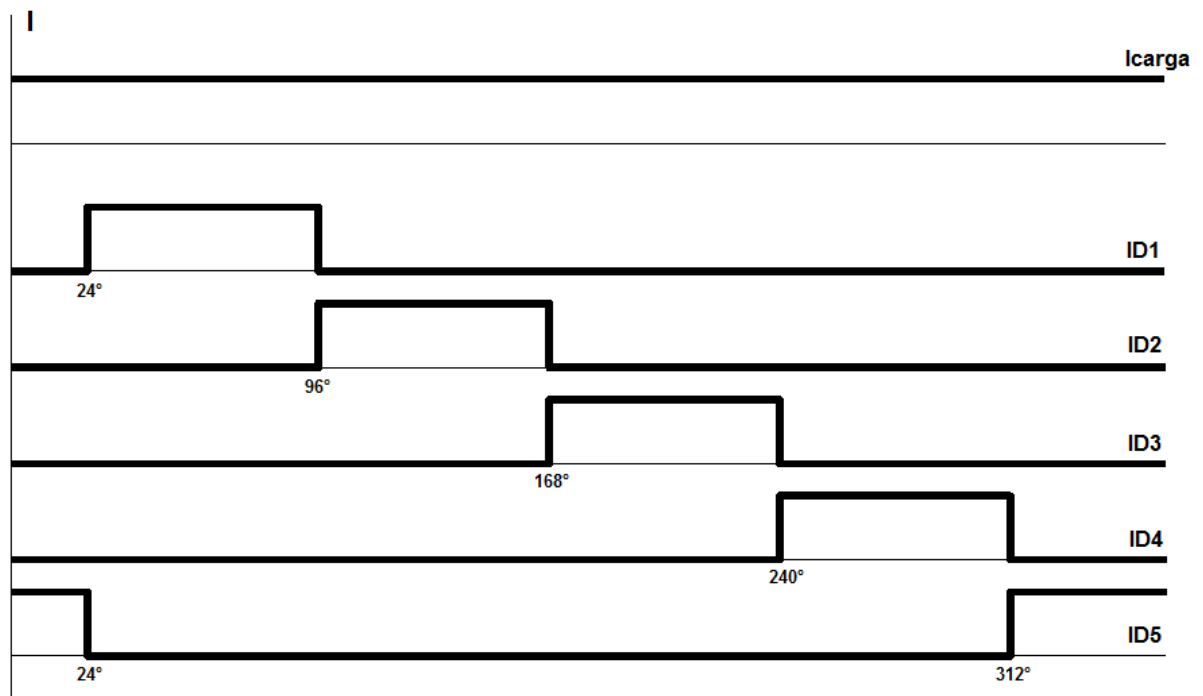
Figura 17: Distribuição temporal, em um ciclo da rede, da corrente de carga nos diodos superiores da ponte Fonte: Autoria própria
