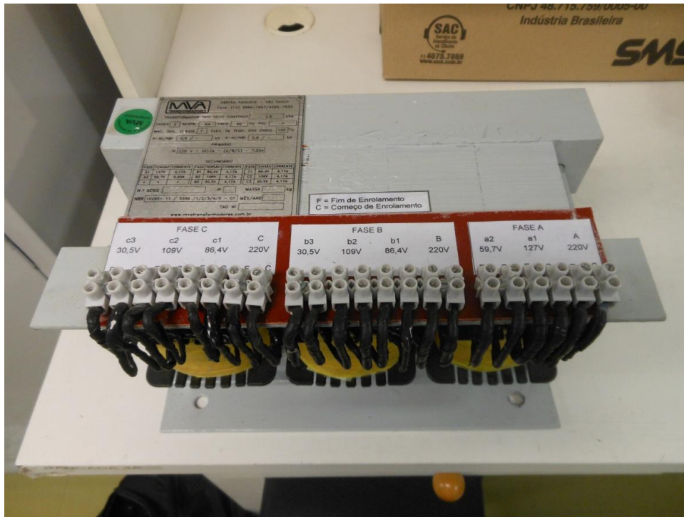
Figura 67: Transformador trifásico-pentafásico do protótipo do retificador. Fonte: Autoria própria
