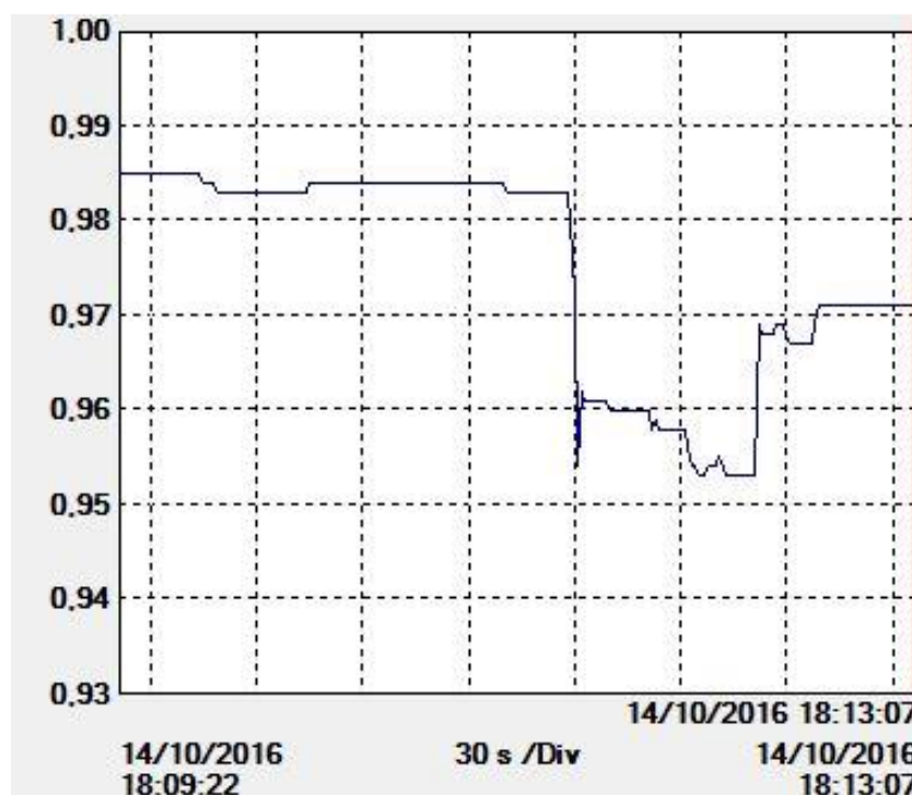
Figura 37 – Variação do fator de potência (gerador). Fonte: Programa computacional PowerPad III (AEMC).
