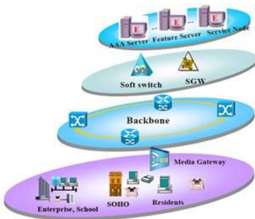
Figura 10: Arquitetura Rede NGN. Fonte: Adaptado de Pinheiro (2015).
