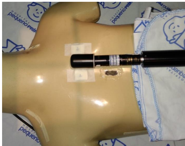
Figura 9: Posição dos pares de TLDs utilizados para a calibração.
