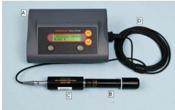
Figura 8: Câmara de ionização cilíndrica, utilizada para a calibração.
