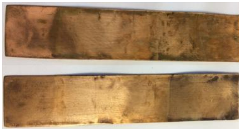
Figura 14 – Eletrodo de cobre após eletrólise. Fonte: OS AUTORES.
