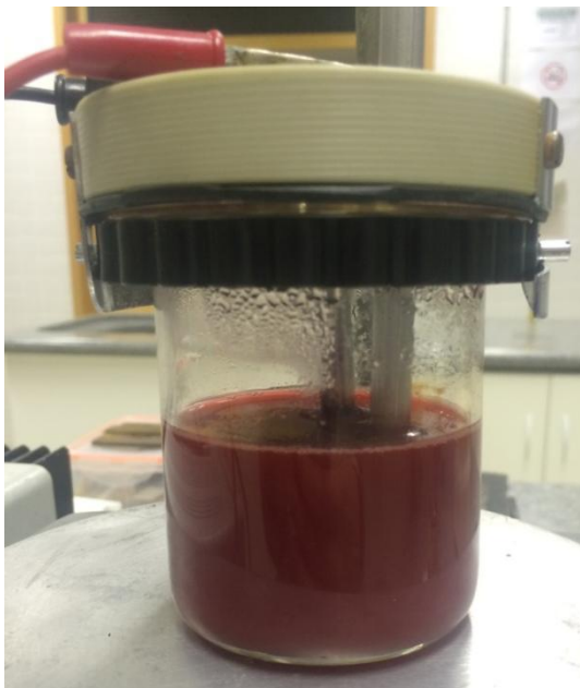
Figura 13 – Eletrólise do corante Vermelho Drimaren com eletrodo de aço inox. Fonte: OS AUTORES.
