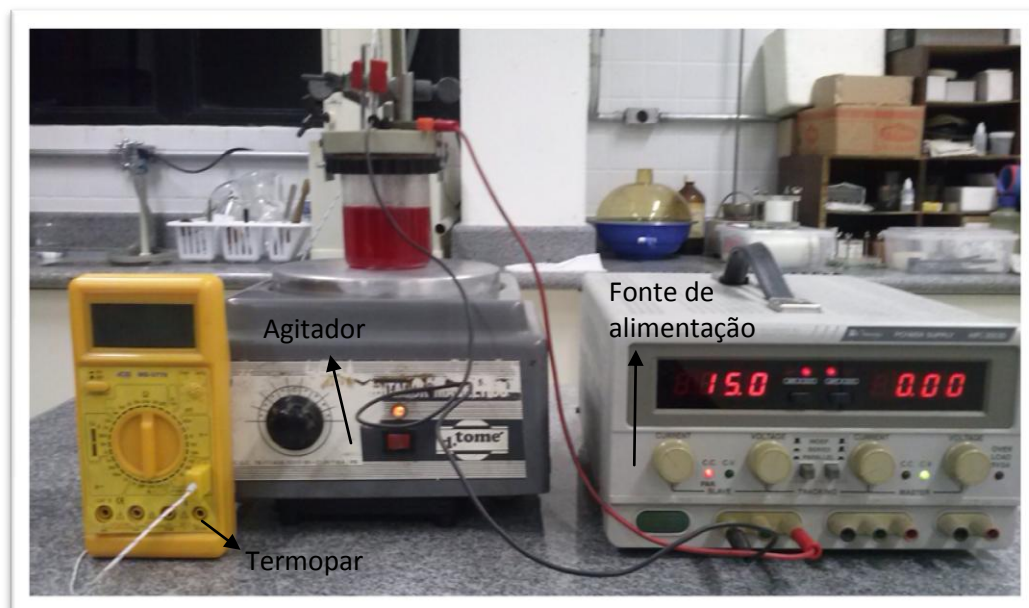
Figura 9 – Sistema completo para a eletrólise. Fonte: OS AUTORES.
