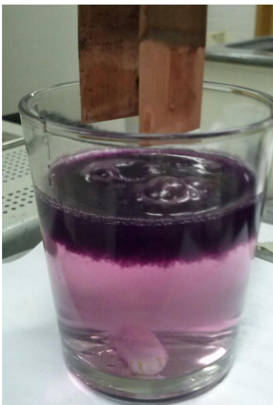
Figura 15 – Solução eletrofloculada de corante Vermelho Drimaren com eletrodo de cobre. Fonte: OS AUTORES.
