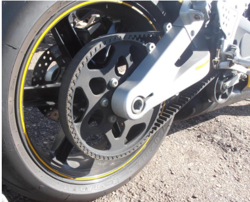
Figura 4 - Exemplo de aplicação de correias em motocicleta Fonte: Autoria própria.
