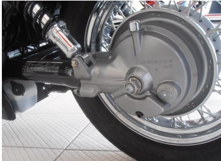
Figura 5 - Exemplo de transmissão por cardã em motocicletas Fonte: Autoria própria.
