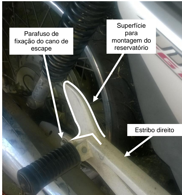
Figura 57 – Região onde foi montado o reservatório Fonte: Autoria própria
