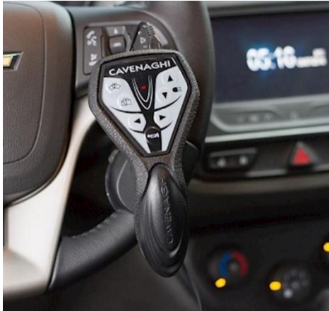
Figura 22. Controle de comandos ERGON CE.
