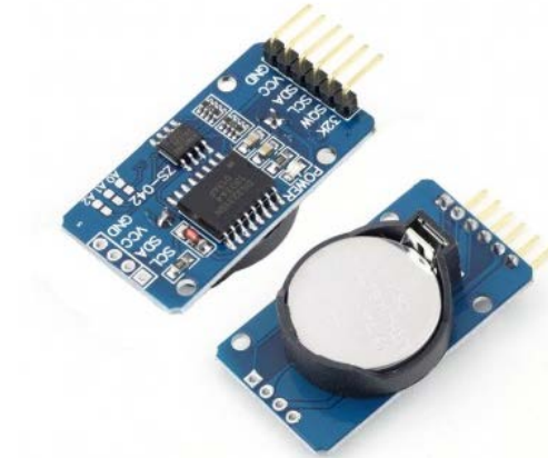
Figura 9– Módulo DS3231 RTC Fonte: www.potentiallabs.com
