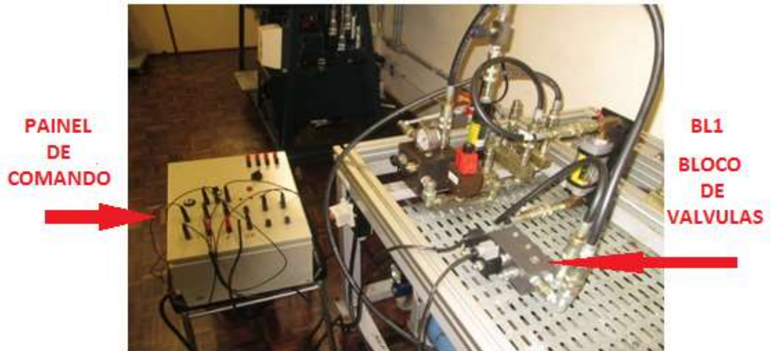
Figura 21: Arranjo montado para o controle dos estágios ou níveis de vazão apresentados nas figuras 6 e 7
