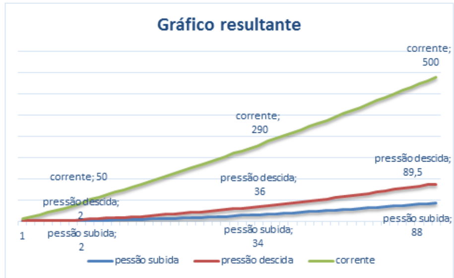
Figura 24: Gráfico obtido com o experimento com um lado da válvula proporcional
