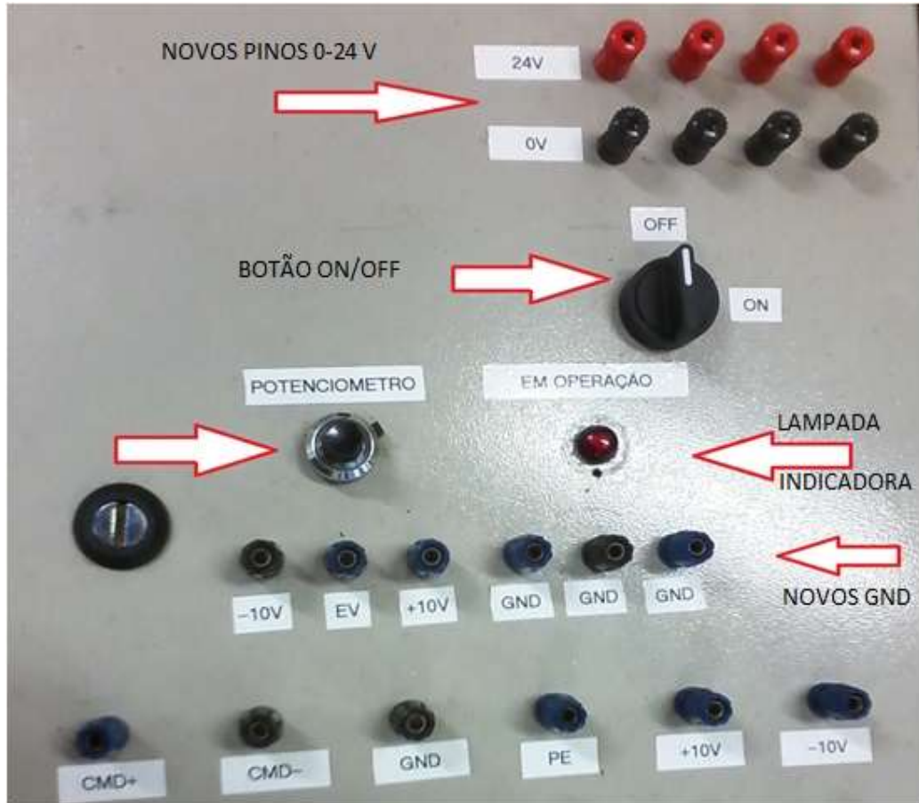
Figura 18: Frontal do Painel de Controle utilizado para o controle proporcional
