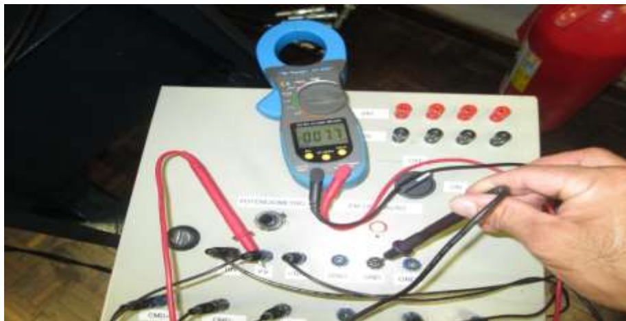
Figura 11: Teste de variação da tensão de comando
