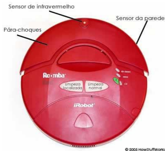
Figura 5 - Detalhe dos sensores superiores. Fonte: Layton (2005).
