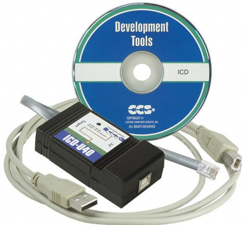
Figura 29: Hardware de programação ICD-U40. Fonte: Media Digikey (2013).
