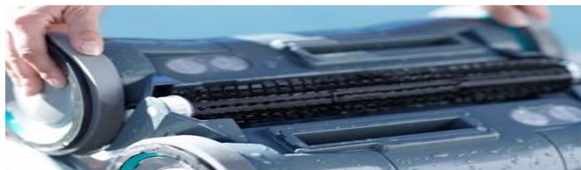
Figura 15 - Escovas do robô Mirra da IRobot. Fonte: Irobot (2013).
