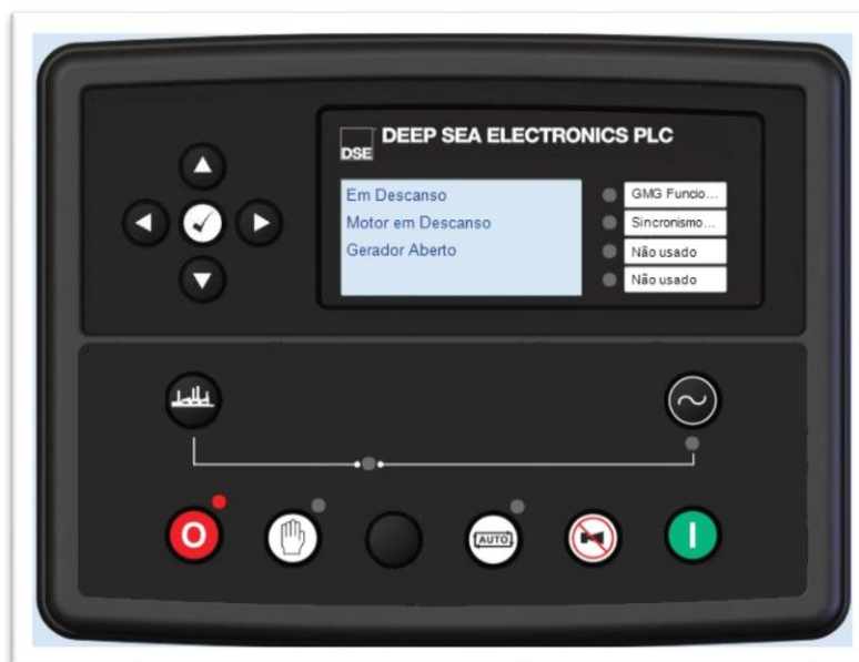
Figura 19 - Módulo DSE8610 Fonte: Autoria própria, imagem do sistema SCADA, 2015.
