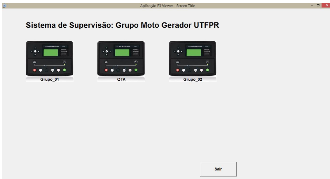
Figura 33 - Primeira tela do sistema de supervisão Fonte: Autoria própria, 2015.
