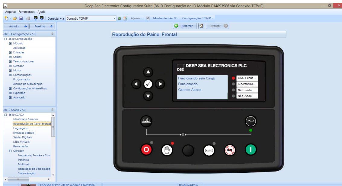
Figura 53 - Sistema SCADA via TCP/IP Fonte: Autoria própria.
