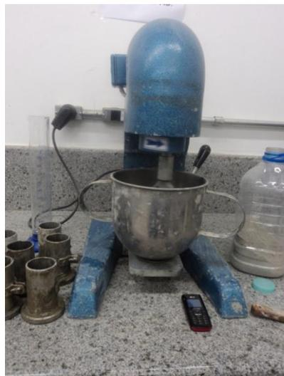
Figura 4 – Misturador Mecânico - laboratório UTFPR
