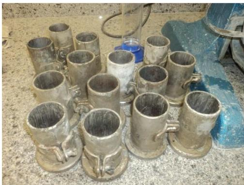
Figura 6 – Moldes Cilíndricos 5x10cm
