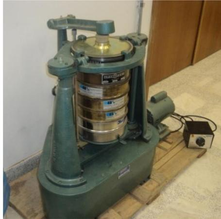
Figura 3 - Peneirador mecânico
