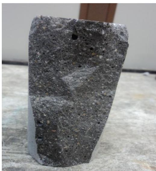
Figura 10 - Corpo de prova rompido
