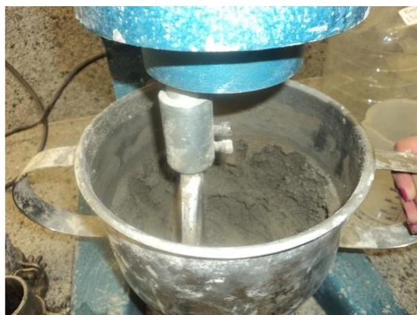
Figura - 5 Mistura mecânica dos materiais
