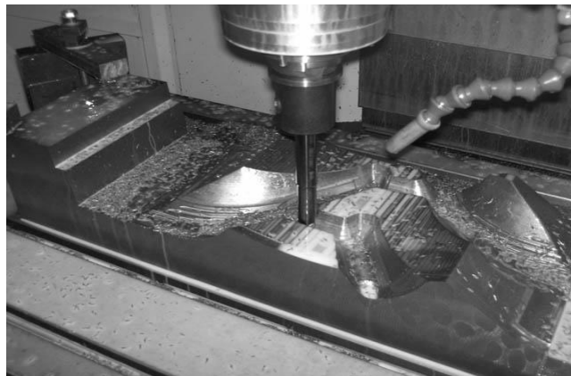
Figura 5 – Fresamento da cavidade do molde Fonte: Almater (2013)
