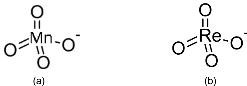
Figura 36. Estrutura dos íons tetraédricos: a) permanganato, empregado na reação T2 e b) perrenato, empregado na reação T8 .
