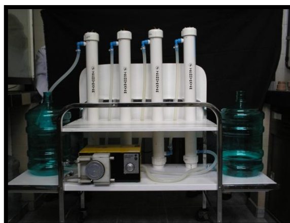
A B Figura 8 - Esquema (A) e vista frontal (B) da unidade de tratamento contínuo, operada com radiação artificial.
