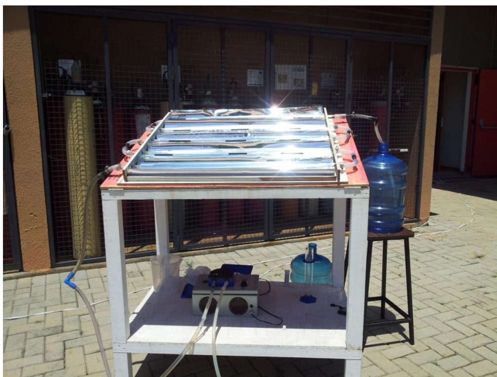
Figura 20 - Fotografia retirada durante a preparação do reator para passagem de solução na saída de emergência do bloco C da UTFPR.
