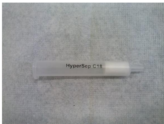
Figura 4- Amostrador utilizado, cartuchos de extração contendo fase estacionária C-18.
