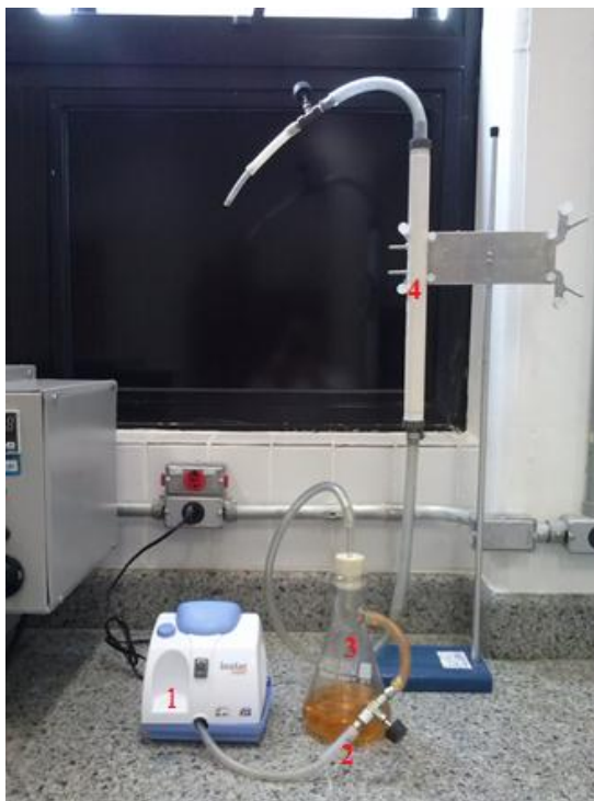
Figura 5- Sistema de preparo e secagem dos amostradores. 1) Bomba inalação; 2) Controlador de vazão; 3) Kitassato contendo solução de dicromato de potássio ( K_2Cr_2O_7 ); 4) Tubo de cloreto de polivinila (PVC) contendo sílica e carvão ativado.
