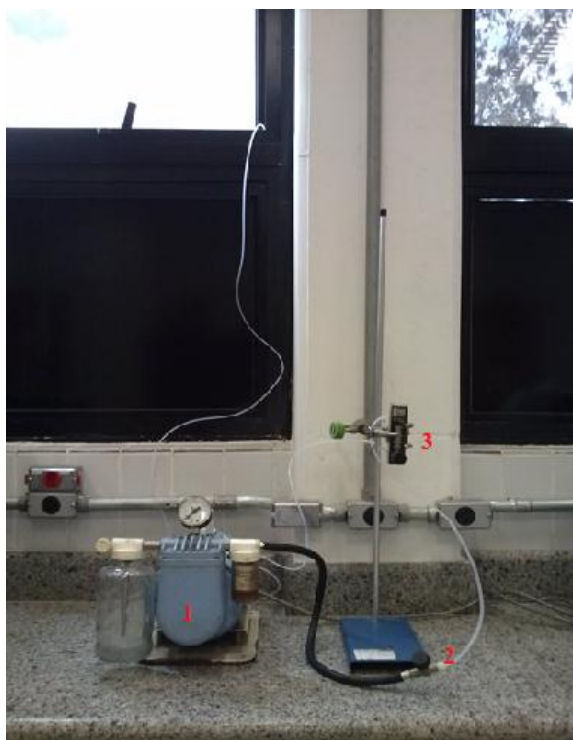
Figura 6- Sistema de amostragem ativa. 1) Bomba a vácuo; 2) Controlador de vazão; 3) Medidor de vazão.
