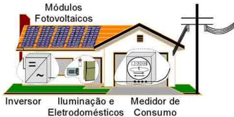
Figura 2.17 – Esquema de um sistema fotovoltaico residencial conectado à rede Fonte: NT-SOLAR –PUCRS (2009)
