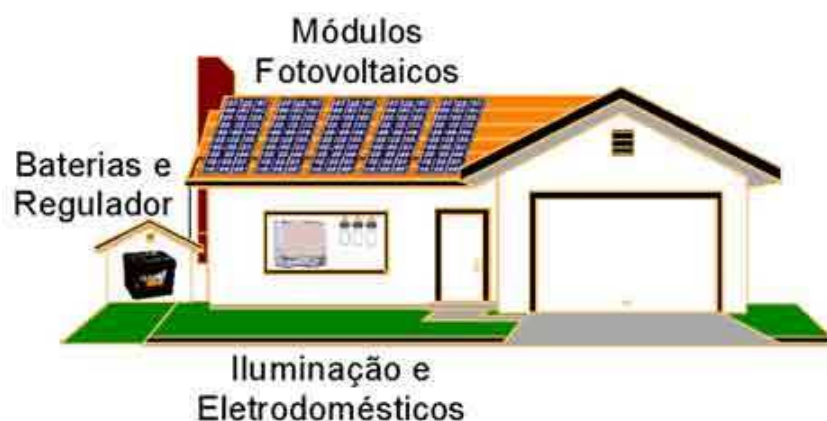
Figura 2.16 – Esquema de um sistema fotovoltaico residencial autônomo Fonte: NT-SOLAR –PUCRS (2009)
