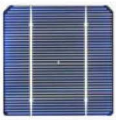
Figura 2.4 – Célula monocristalina Fonte: Saraiva Leão (2008)
