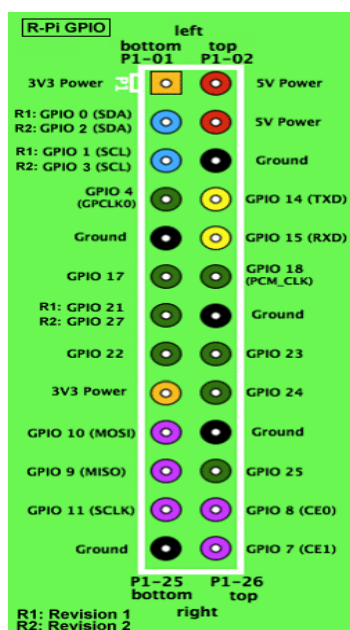
Figura 10 - Pinagem da porta P1 da Raspberry Pi – Model B Fonte: Wikipedia (2014)
