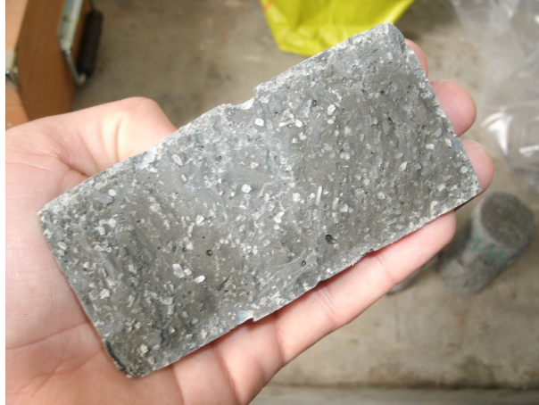
Figura 16: Poros internos - Traço 2 Fonte: o autor, 2013.
