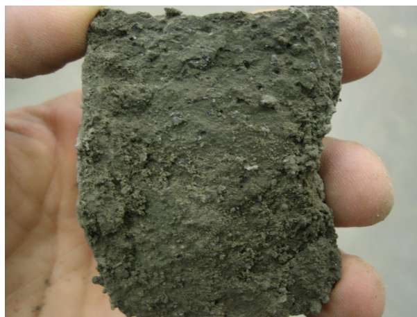
Figura 15: Poros internos - Traço 1 Fonte: o autor, 2013.
