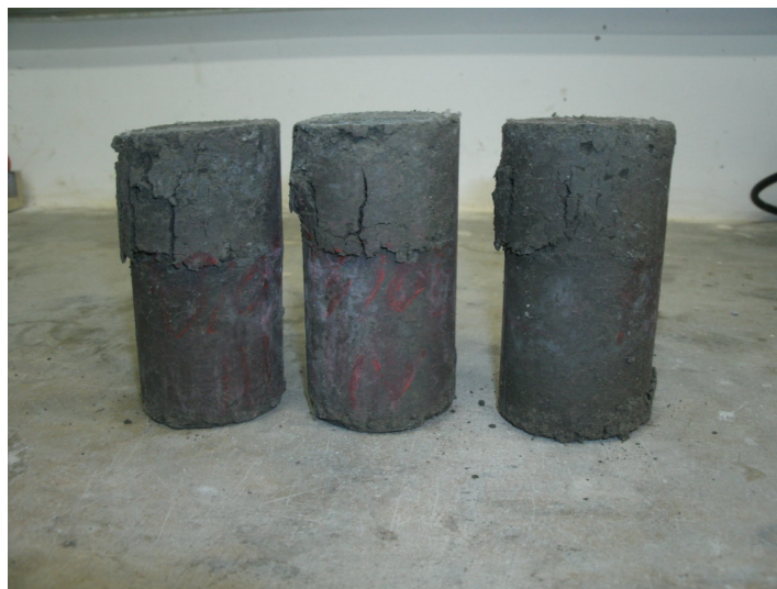
Figura 17: Ruptura a compressão axial - Traço 1 Fonte: o autor, 2013.
