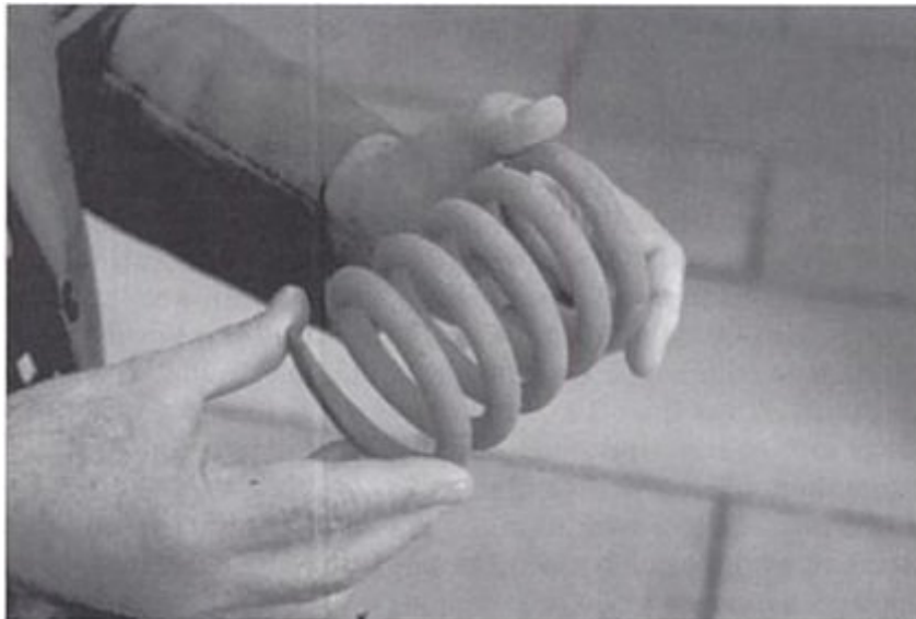
Figura 7: Mola de carro fabricada com concreto isento de macro-defeitos Fonte: Bennett, 2002.
