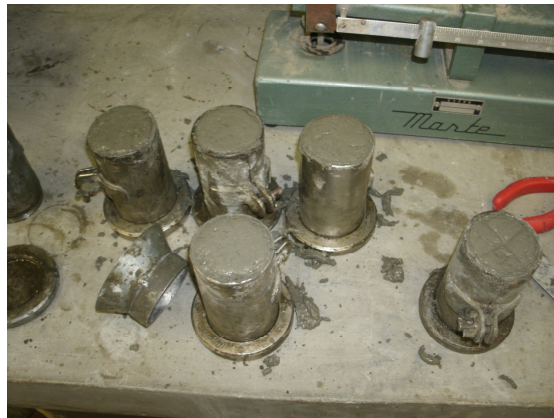
Figura 14: Acondicionamento nos moldes Fonte: o autor
