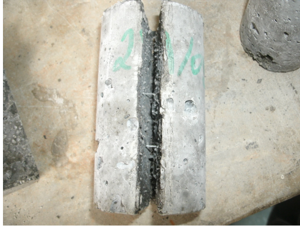
Figura 21: Ruptura na compressão diametral - Traço 2 Fonte: o autor, 2013.
