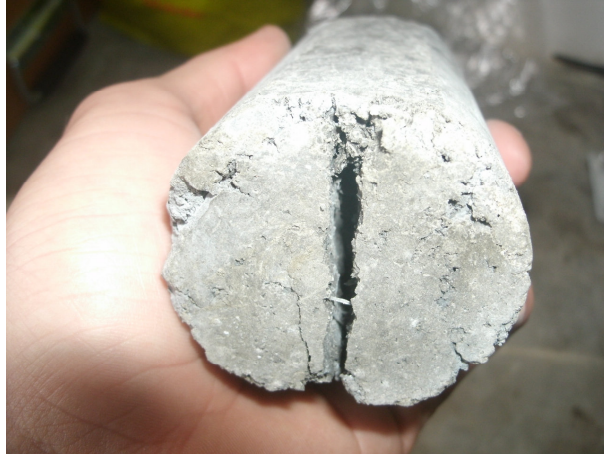
Figura 23: Ruptura na compressão diametral - Traço 3 Fonte: o autor, 2013.
