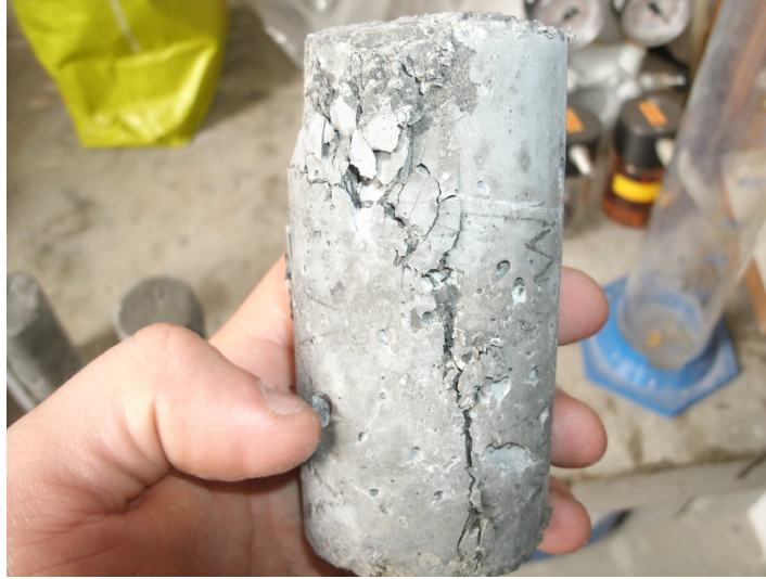
Figura 18: Ruptura a compressão axial - Traço 2 Fonte: o autor, 2013.
