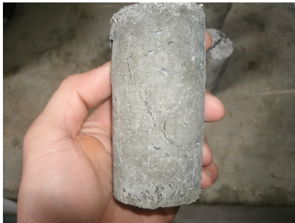
Figura 22: Ruptura na compressão axial - Traço 3 Fonte: o autor, 2013.
