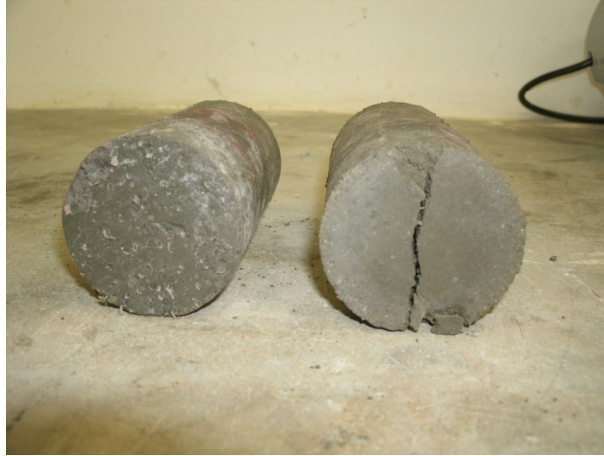
Figura 19: Ruptura na compressão diametral - Traço 1 Fonte: o autor, 2013.
