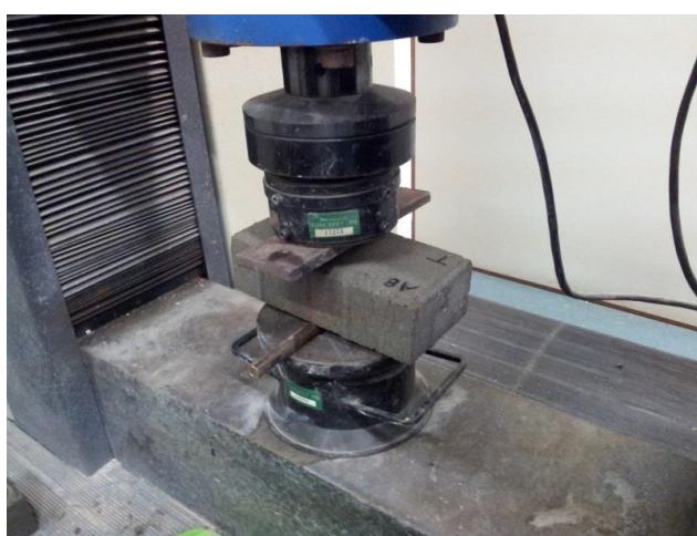
Figura 14 - Compressão diametral Fonte: Autoria própria.
