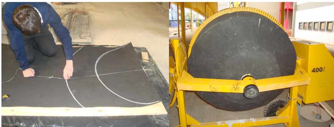
Figura 13 – Betoneira com revestimentos acústicos (EVA) Fonte: Autores (2013)
