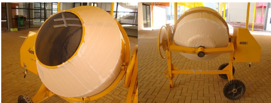
Figura 12 – Betoneira com preparação de revestimentos acústicos (EVA) Fonte: Autores (2013)
