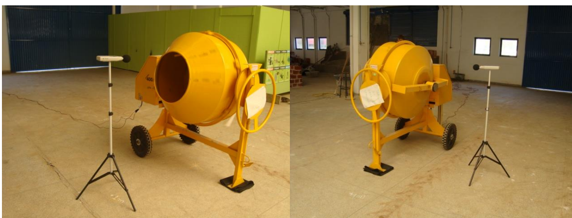
Figura 10 – Betoneira sem revestimentos acústicos Fonte: Autores (2013)
