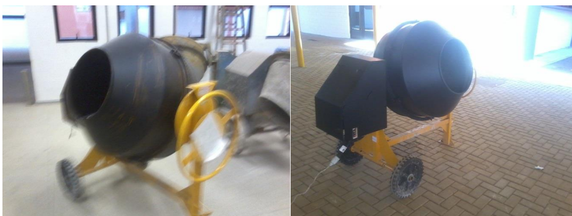
Figura 14 – Betoneira com revestimentos acústicos (Látex) Fonte: Autores (2013)
