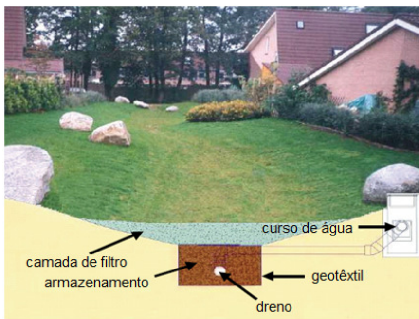
Figura 13 – Valetas de infiltração em Enschede, Holanda Fonte: Adaptado de Beenen e Boogaard (2007)
