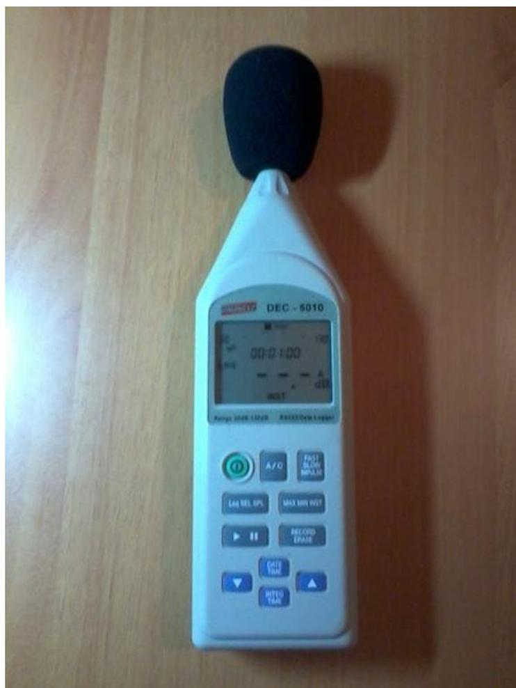
Figura 2 – Medidor de Nível de Pressão Sonora DEC-5010
