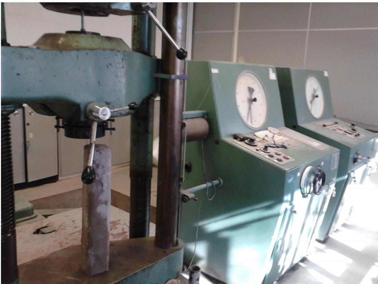
**Figura 14 - Prensa utilizada nos ensaios de ruptura**
