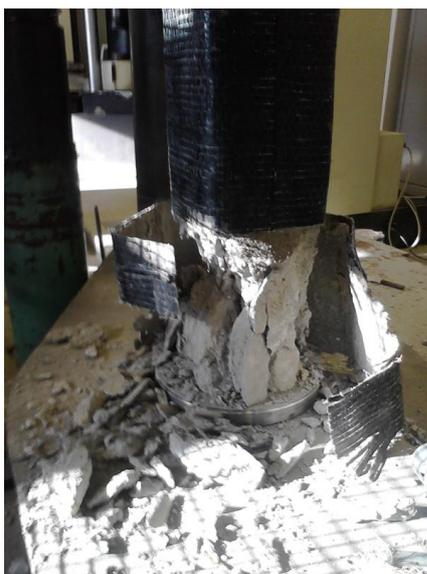
**Figura 15 - Pilar rompido na emenda do reforço**
