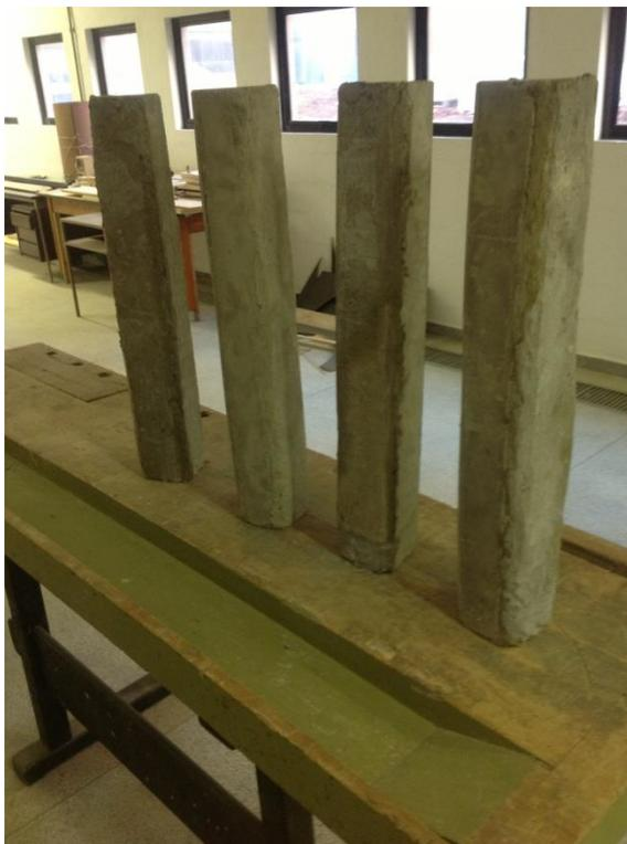
**Figura 8 - Pilares regularizados com argamassa polimérica**
