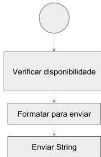
Figura 19 - Representação do funcionamento do Bluetooth
