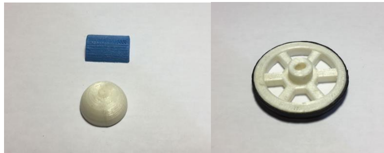
Figura 22 – Modelo final dos apoios frontais e da roda
