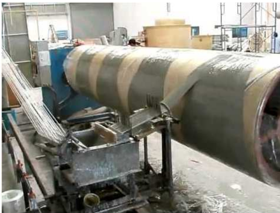
FIGURA 3 – Processo de enrolamento filamentar Fonte: Youtube
