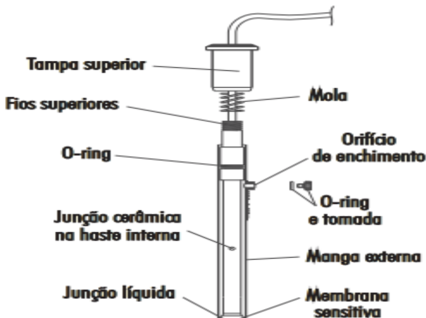
Figura 11 – Desenho esquemático do eletrodo. Fonte: HANNA Instruments (2016).
