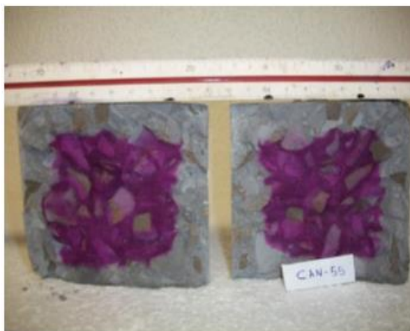
Figura 6. Aspersão de fenolftaleína após o rompimento de um CP. Fonte: Tasca, 2012.
