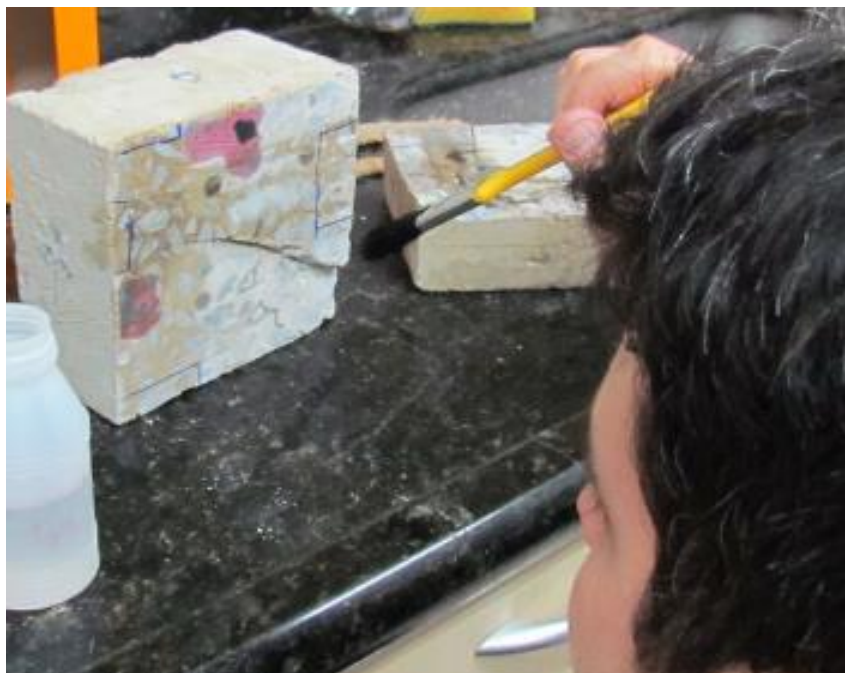
Figura 13. Aplicação da fenolftaleína em pontos específicos por pincel Fonte: autoria própria.
