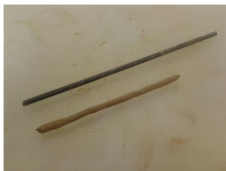
Figura 27 – Ensaio de limite de plasticidade Fonte: Autoria Própria (2016)
