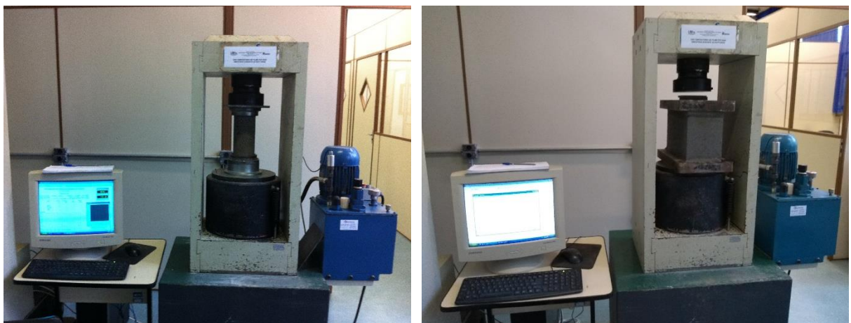
Figura 43 - Ensaio de Resistência à Compressão Axial
