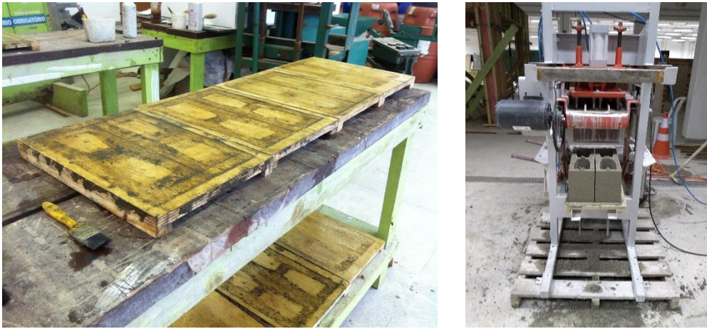
Figura 44 - Aplicação de Desmoldante nas Formas e Moldagem dos Blocos
