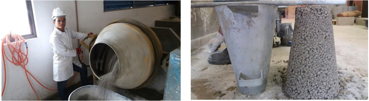
Figura 42 - Mistura do Concreto em Betoneira e Ensaio Slump Test
