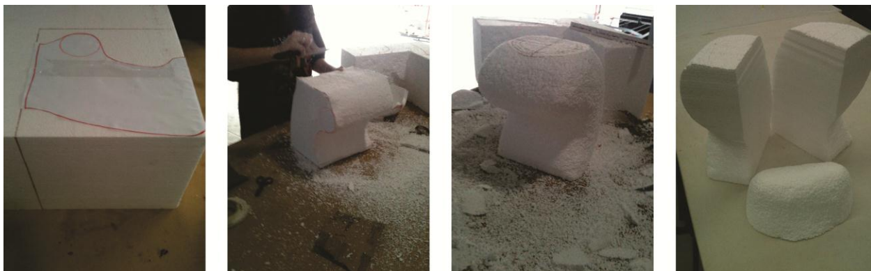
Figura 61: Fases de construção do modelo Fonte: Autoria própria.
