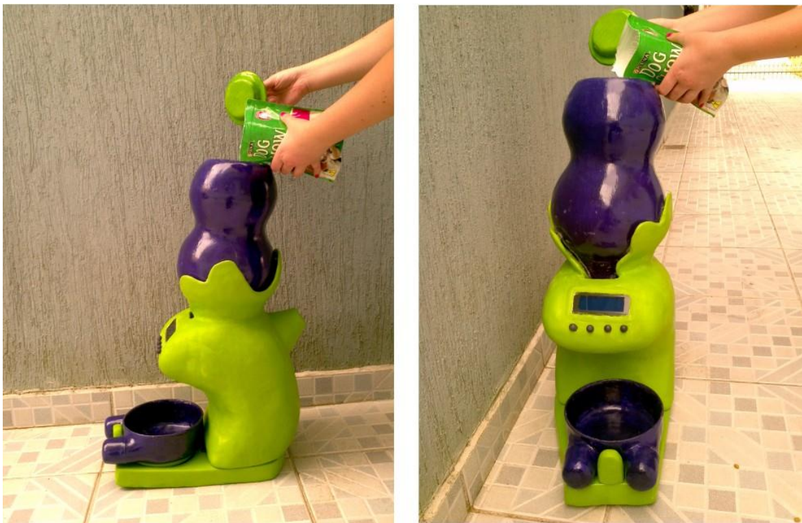
Figura 64: Preenchimento do pote de armazenamento Fonte: Autoria própria.
