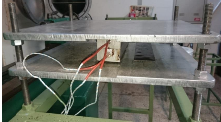
Figura 8 - Matriz aquecedora. Fonte: Autoria própria.
