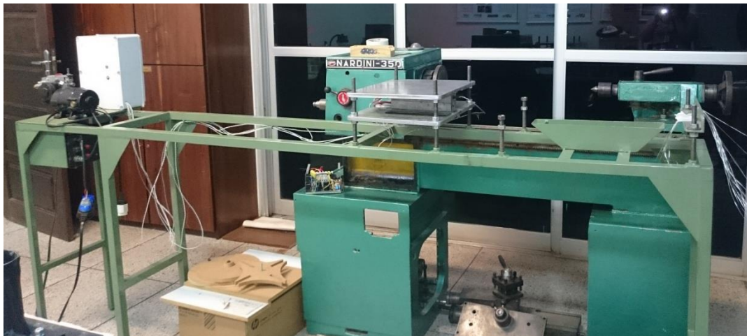
Figura 5 - Máquina pultrusora no laboratório de Materiais Universidade Tecnológica Federal do Paraná - Câmpus Cornélio Procópio. Fonte: Autoria própria.
