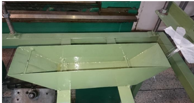
Figura 7 - Banheira de impregnação da Resina.
