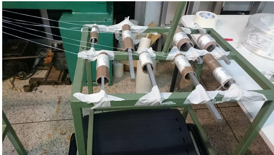
Figura 11: Sistema improvisado para tracionando dos fios de fibra de vidro Fonte: Autoria própria.
