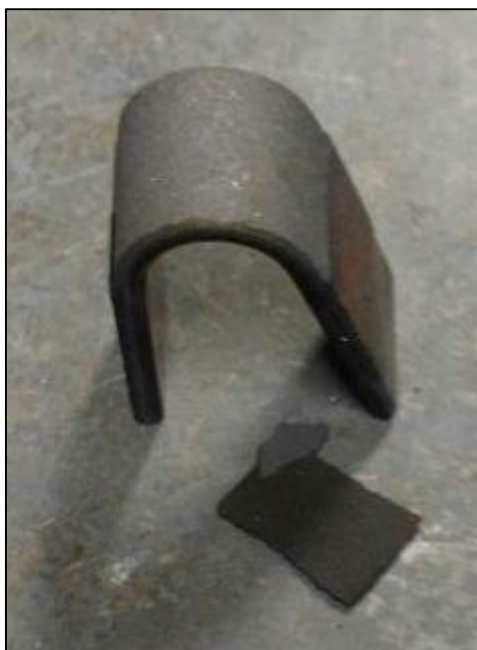
Figura 22 - Ensaio de dobramento na amostra com 2% de alumina. Fonte: Autoria própria, 2017.
