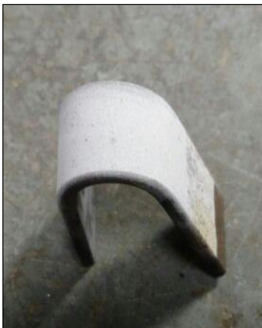
Figura 23 - Ensaio de dobramento na amostra com 8% de alumina. Fonte: Autoria própria, 2017.
