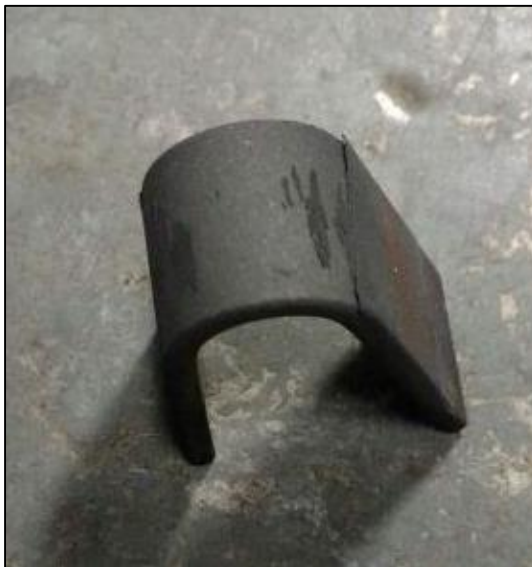
Figura 21 - Ensaio de dobramento na amostra com 1% de alumina. Fonte: Autoria própria, 2017.
