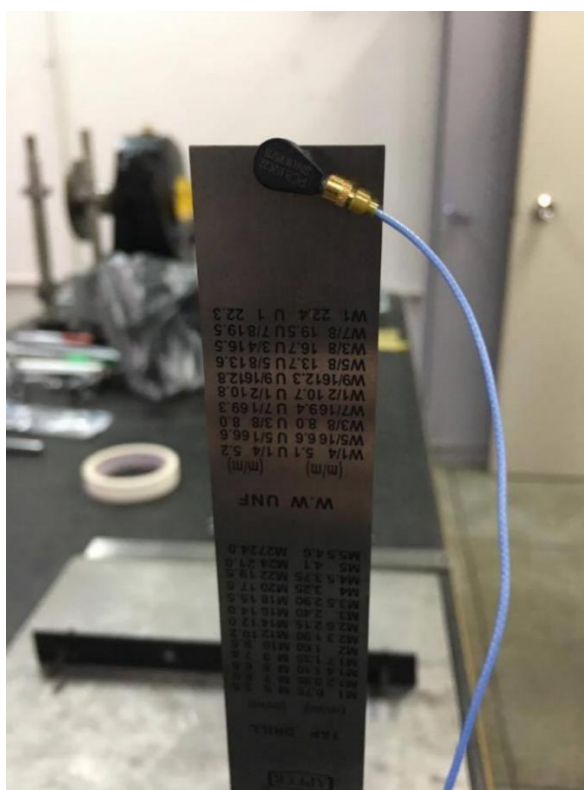
Figura 7 - Acelerômetro e viga Fonte: Autoria própria.
