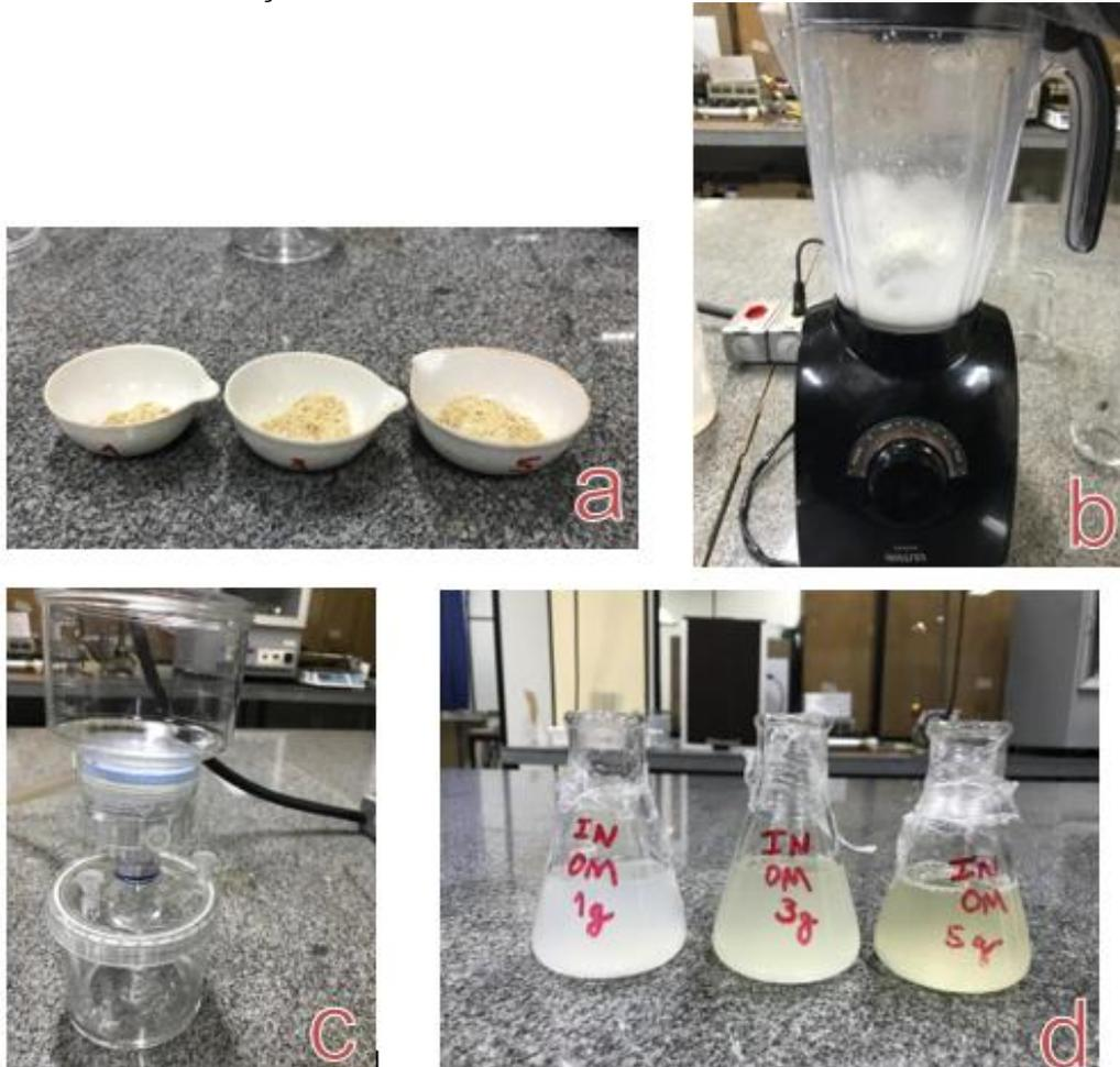
Para solução salina, utilizou a mesma metodologia descrita acima, a partir de um grama de semente de moringa para 0,1 litro de solução salina de NaCl de concentração 0,5 e 1,5 M.
