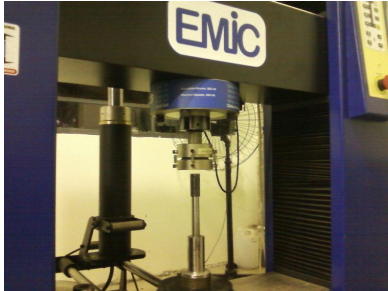
Figura 1– Prensa hidráulica preparada para confecção dos corpos de prova Fonte: Autoria própria.
