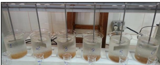
Figura 18 - Flocos formados após desligar o Jar Test.
