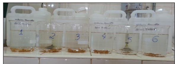
Figura 19 - Flocos formados uma hora após desligar o Jar Test.
