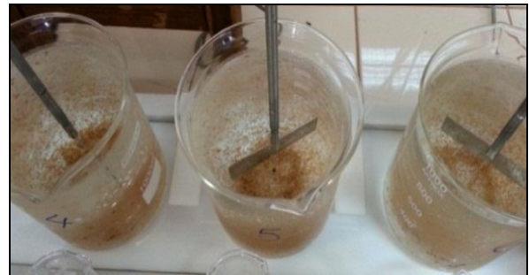
Figura 17 - Formação de flocos com solução de goma xantana diluída a frio.
