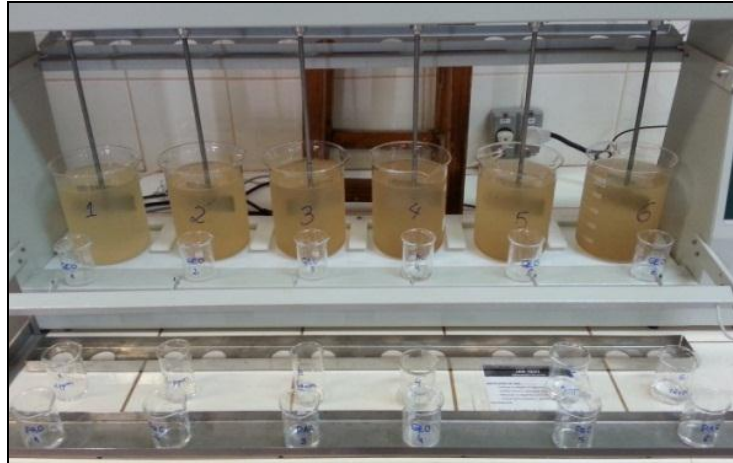
Figura 10 - Ensaio com goma xantana como auxiliar de floculação.
