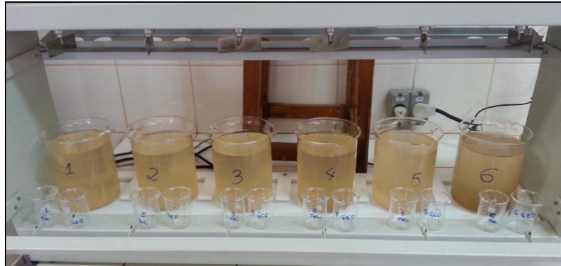
Figura 9 - Ensaio para a determinação da concentração ótima de coagulante.
