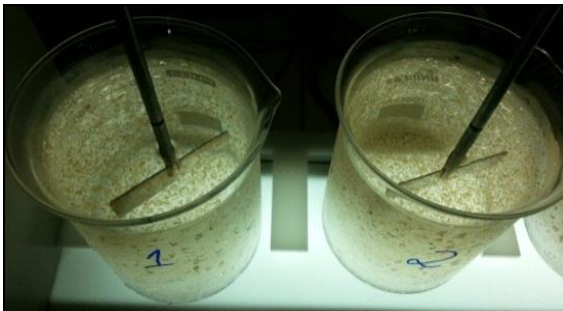
Figura 16 - Formação de flocos com solução de goma xantana diluída a frio.
