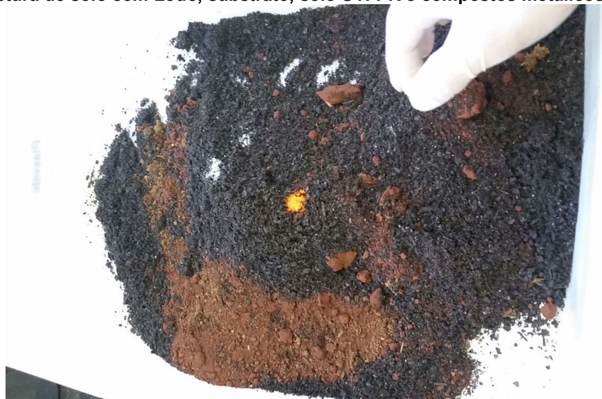
Figura 4: Mistura de solo com Lodo, substrato, solo UTFPR e compostos metálicos.
