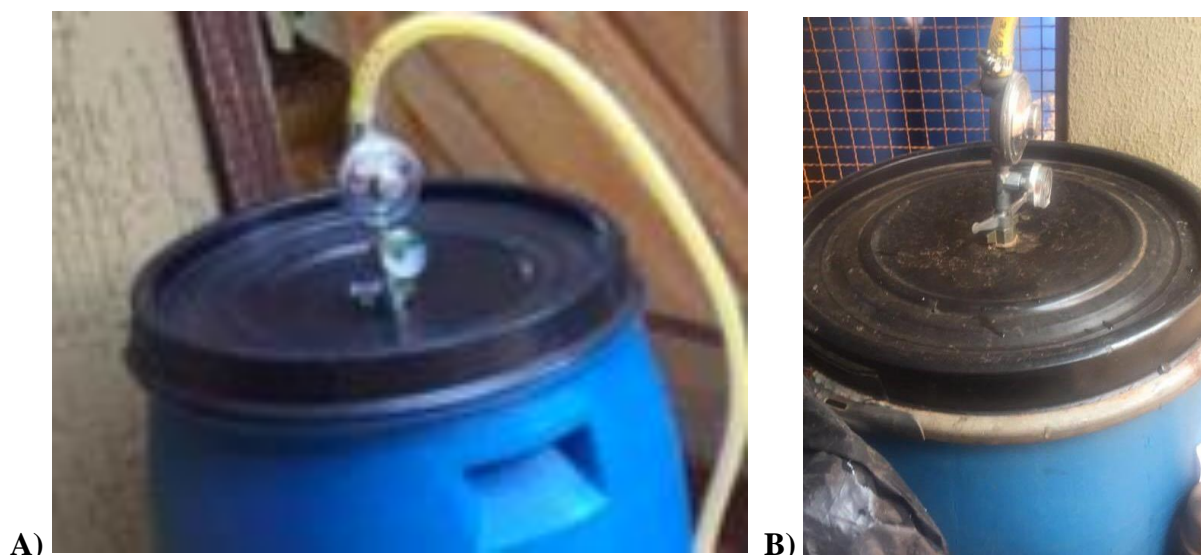
Figura 13 - A) Biodigestor vazio, B) Biodigestor alimentado e fechado por 5 dias para acumulação de gases.
