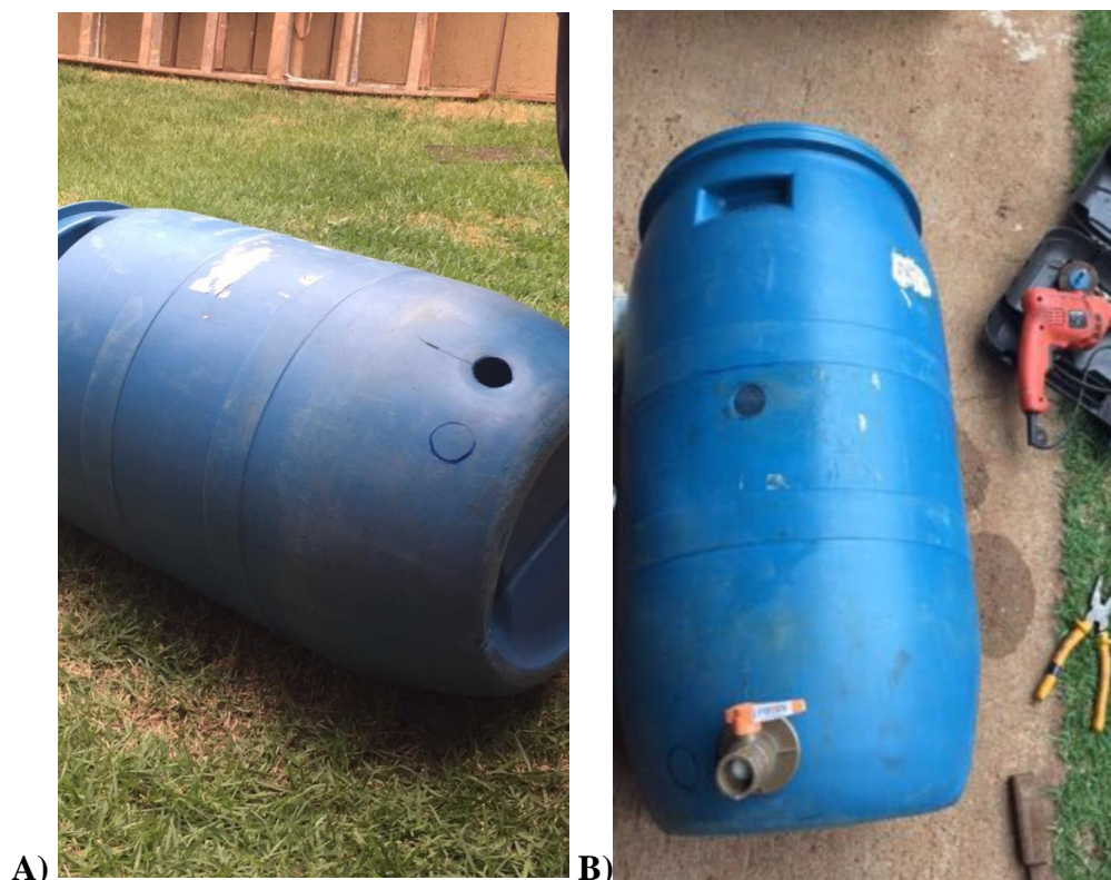
Figura 3 - A) Demarcação com caneta do local de instalação dos registros. B) Instalação dos registros de PVC no biodigestor doméstico.
