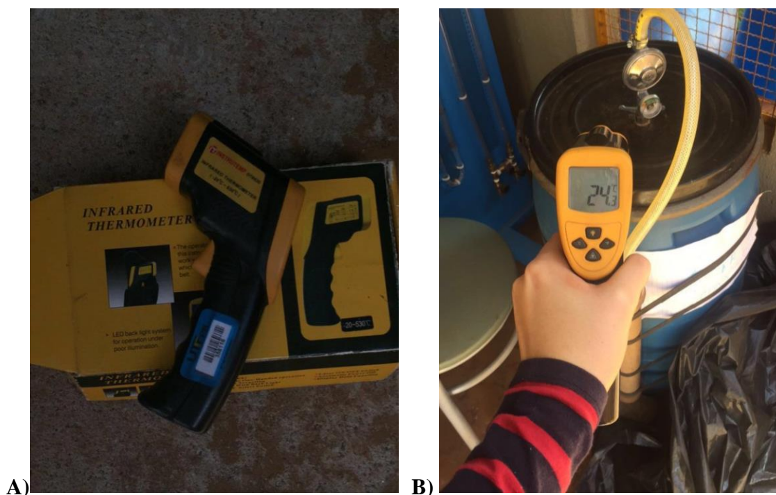
Figura 11 - Termômetro digital utilizado durante a fase de operação do biodigestor. A) Termômetro digital, B) Forma de operação.
