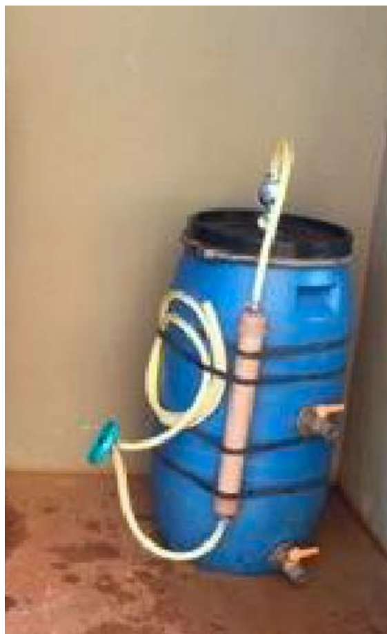
Figura 6 - Biodigestor doméstico com filtro de PVC contendo palha de aço.
