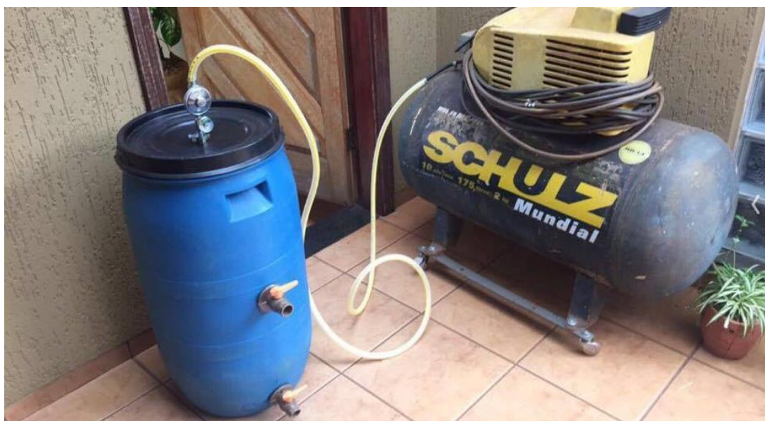
Figura 8 - Teste de vazamento do biodigestor utilizando ar de compressor.
