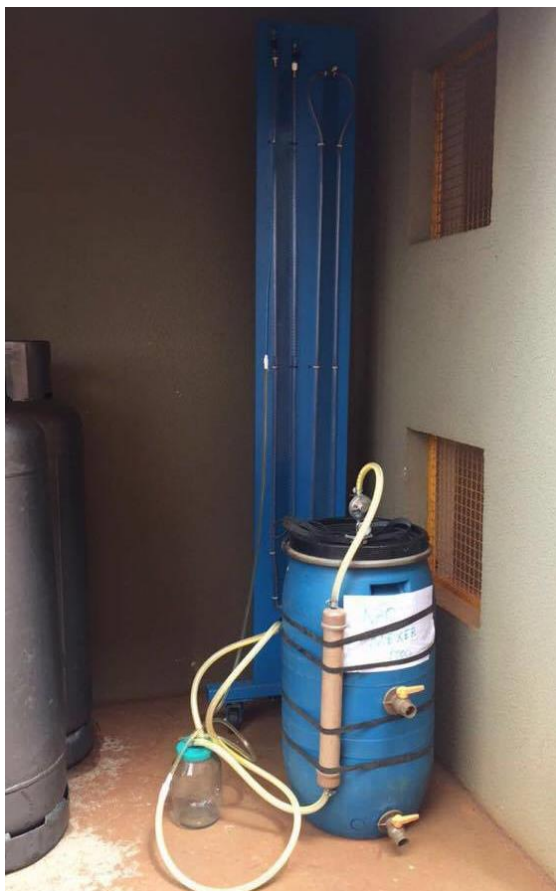
Figura 7 - Biodigestor doméstico e Manômetro em U.
