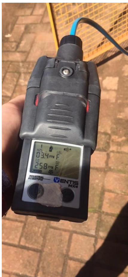
Figura 12 - Sensor de gases Ventis MX 4 utilizado para registro dos gases COx e H 2 S.
