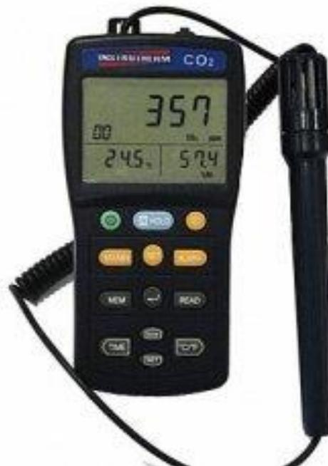
**Figura 4** - Medidor de temperatura e umidade do ar Instrutherm CO<sub>2</sub>
