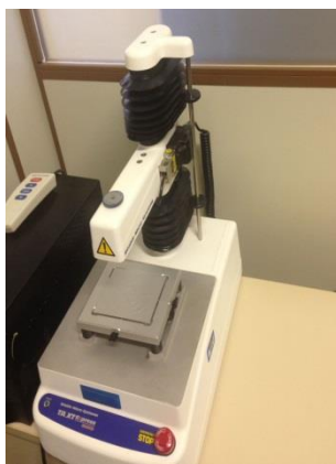
Figura 4: Equipamento utilizado para o Teste de tração e Perfuração, TA-XT Express Enhanced Stable Micro Systems.
