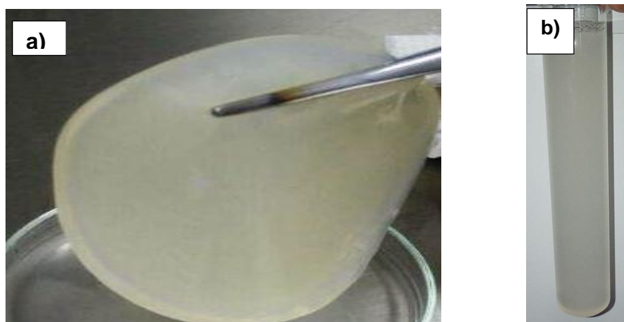
Figura 5: a) Celulose Bacteriana em meio sintético líquido. b) Solução de CB + água destilada
