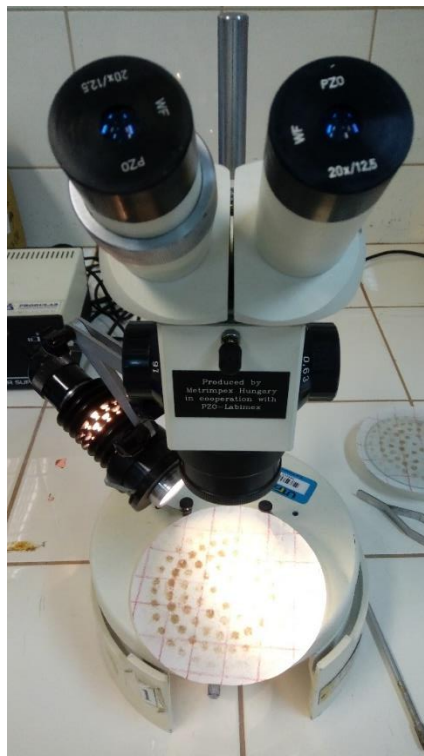
Figura 4 - Material coletado em papel de filtro sendo analisado em microscópio estereoscópico.
