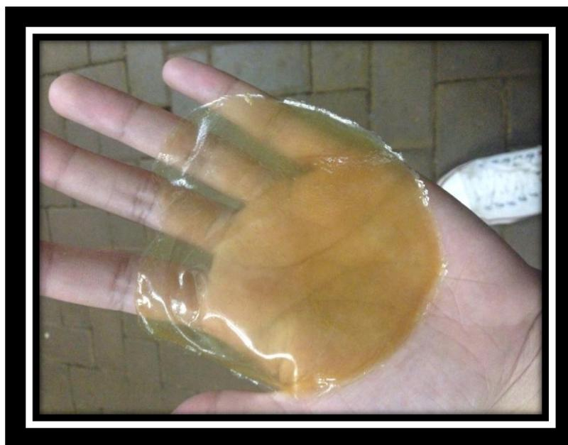
**Figura 8: Filme após 48 horas em estufa.**
