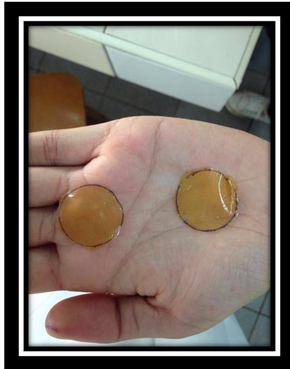
**Figura 10: Discos do filme com 2 cm de diâmetro.**
