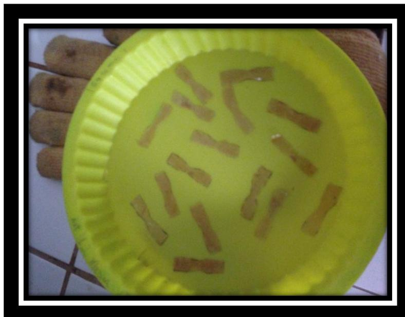
**Figura 9: Tiras do filme para teste análise de espessura.**
