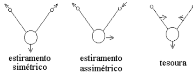
Figura 3.3: Representação esquemática dos modos vibracionais fundamentais da molécula de água
