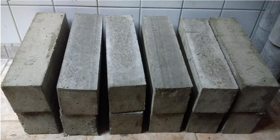
Figura 35 – Corpos de prova prismáticos na câmara úmida.
