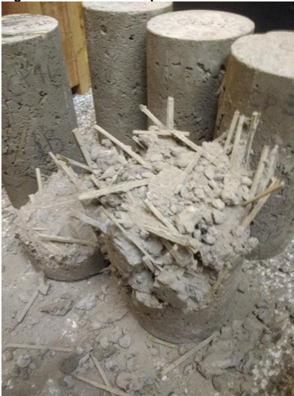
Figura 49 – Forma de ruptura do CP1B.
