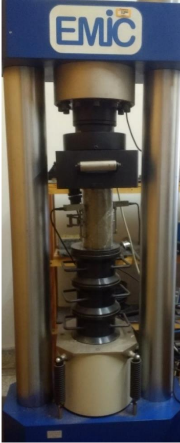
Figura 43 – Corpo de prova pronto para ser ensaiado.
