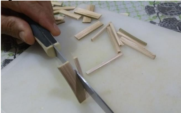
Figura 30 – Fibras de bambu cortadas com faca.
