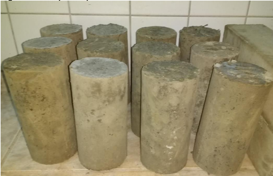
Figura 36 – Corpos de prova cilíndricos na câmara úmida.
