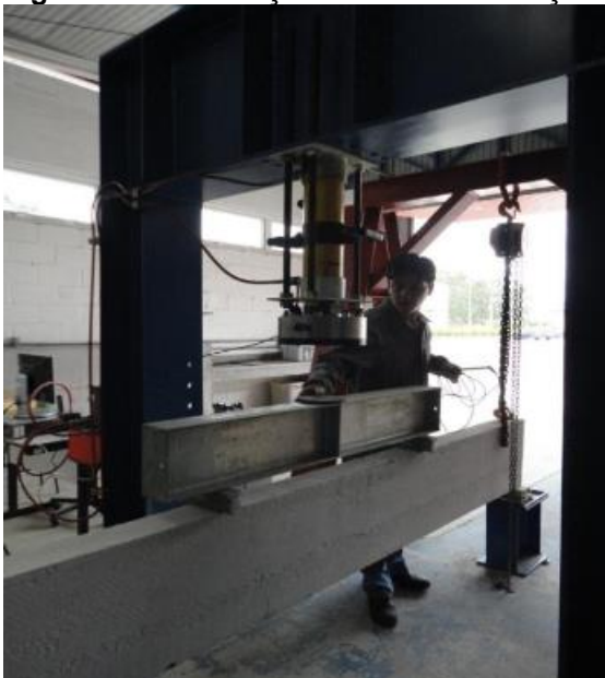
Figura 11 – Realização de ensaio de tração na flexão.
