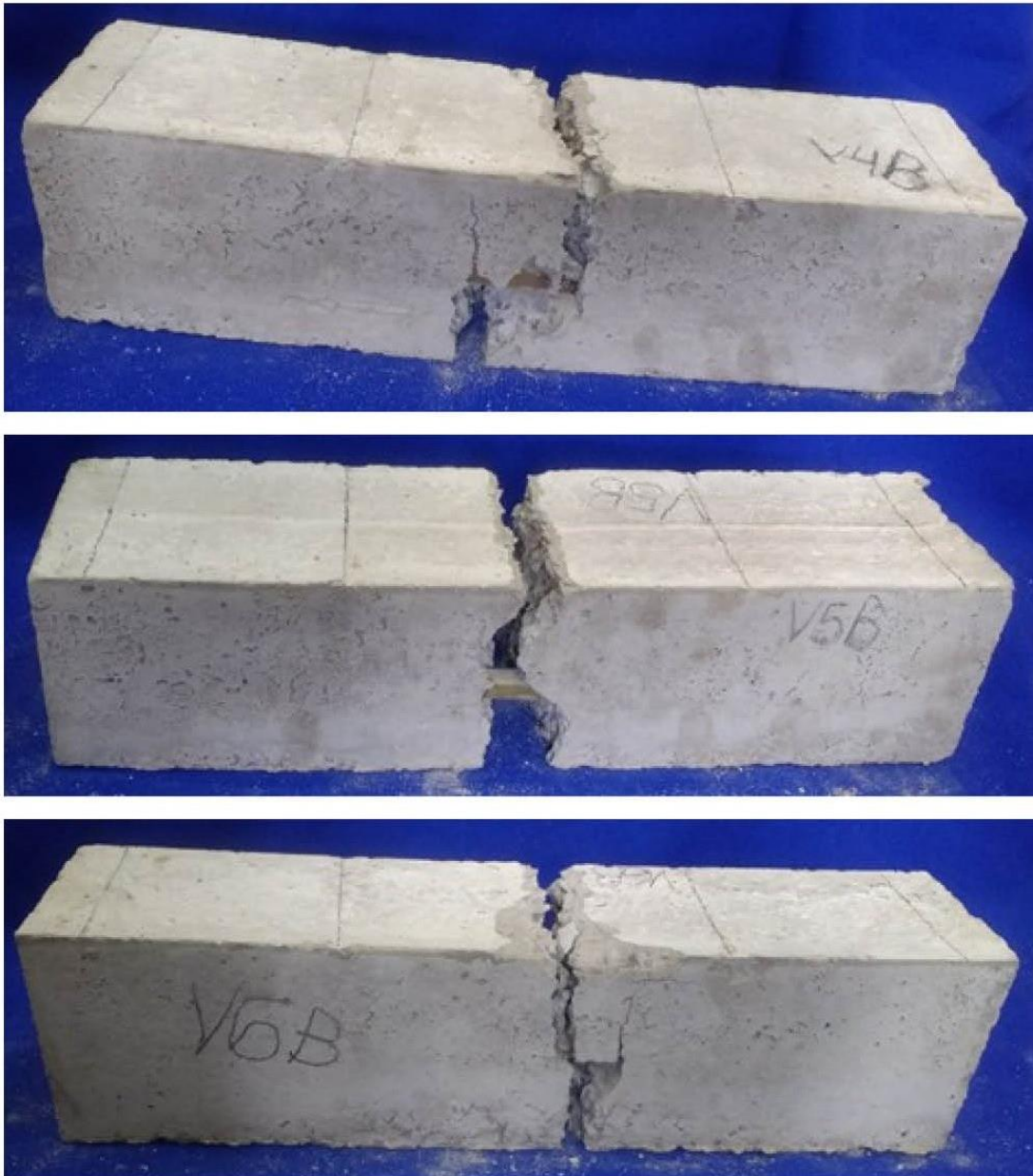
Figura 48 – Corpos de prova V4B, V5B e V6B após realização do ensaio.
