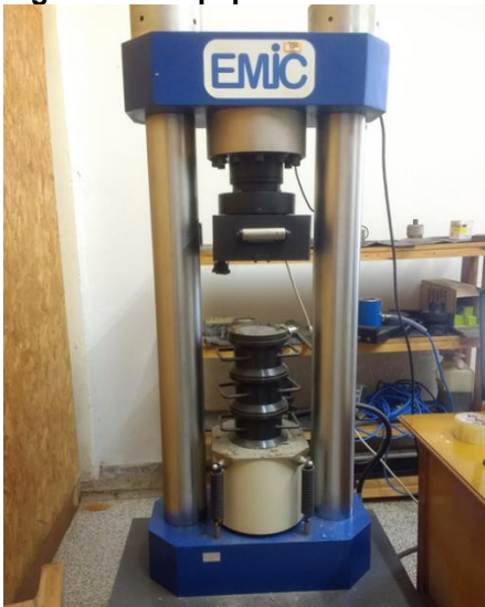
Figura 40 – Equipamento utilizado no ensaio de compressão.
