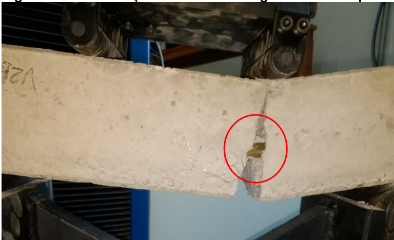
Figura 44 – Localização do bambu na viga durante a ruptura.
