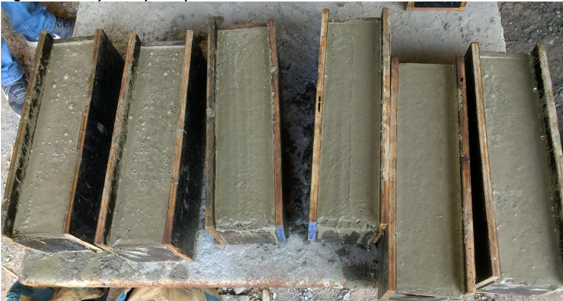
Figura 29 – Corpos de prova prismáticos com bambu finalizados.
