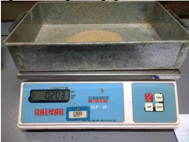
Figura 23 – Pesagem do agregado miúdo.
