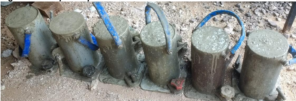
Figura 34 – Corpos de prova cilíndricos moldados.
