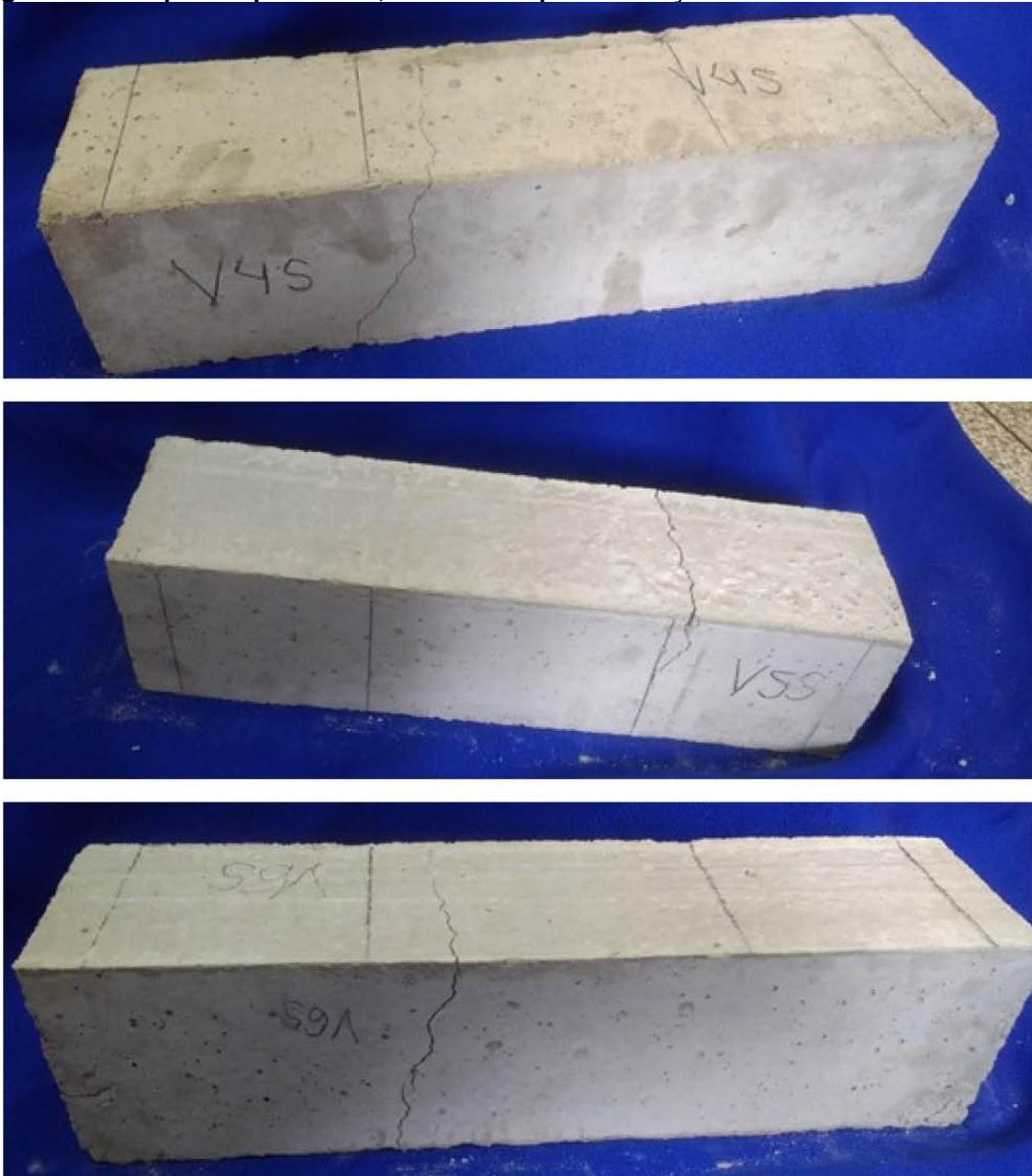
Figura 46 – Corpos de prova V4S, V5S e V6S após realização do ensaio.
