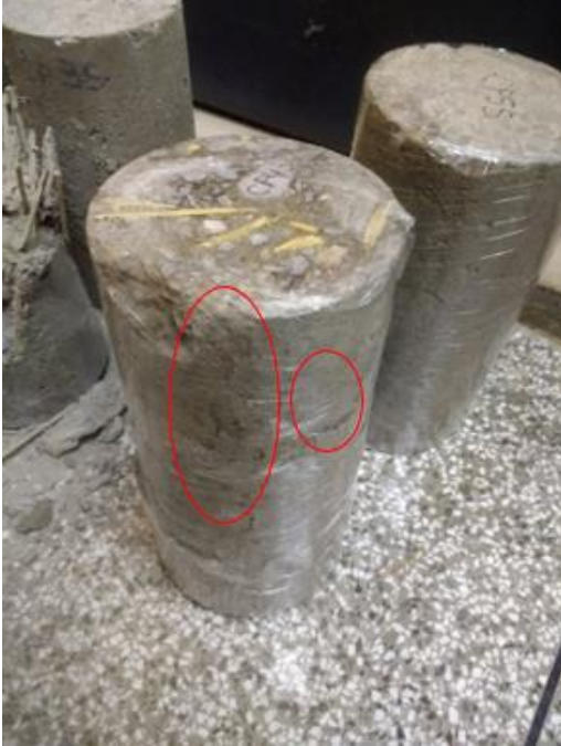
Figura 50 – Fissuras no corpo de prova envolto com papel filme.
