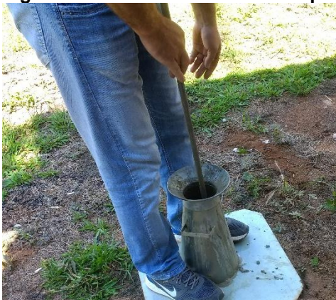
Figura 24 – Ensaio do abatimento pelo tronco do cone.
