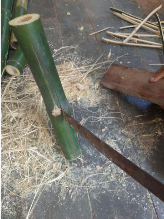
Figura 19 – Colmo já cortado com auxílio de um facão.
