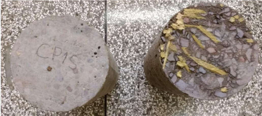
Figura 41 – Diferença visual entre um corpo de prova sem bambu e com bambu, respectivamente.
