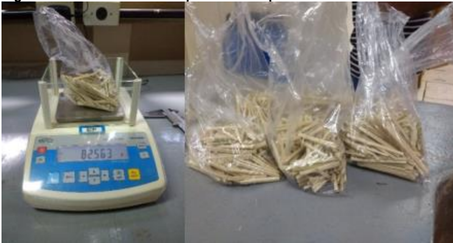
Figura 32 – Fibras de bambu pesadas e separadas.
