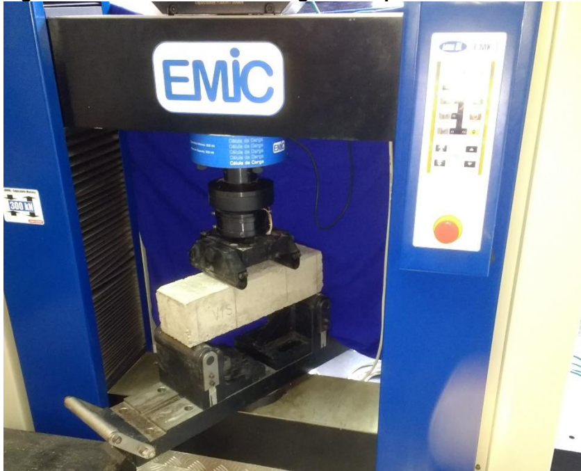
Figura 37 – Posicionamento da viga na máquina universal.
