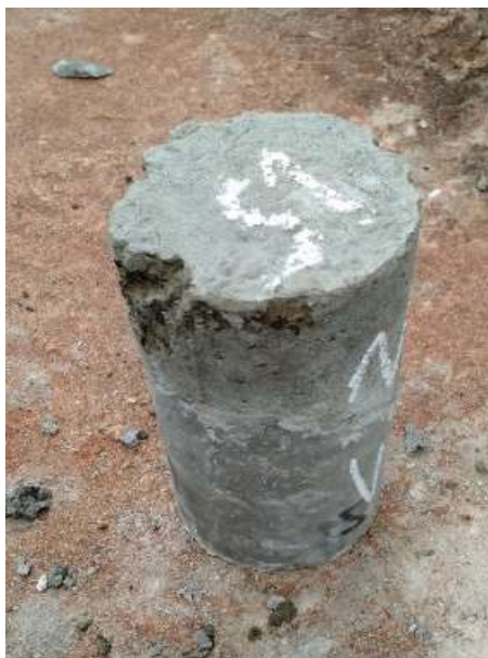
Figura 17 - Rompimento no concreto novo (Sikadur 32)
