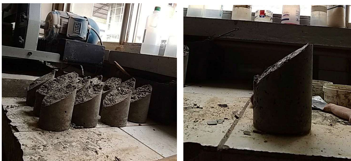
Figura 7 — Corpos de prova desmoldados aguardando recuperação
