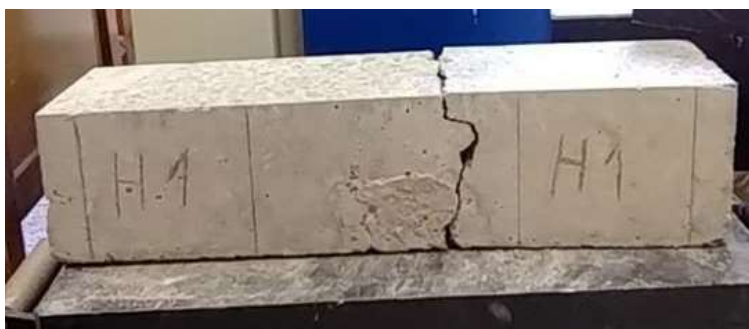
Figura 24 – Rompimento no concreto novo/interface de ligação entre concreto novo e velho do corpo de prova 1 reparado com Hardfix
