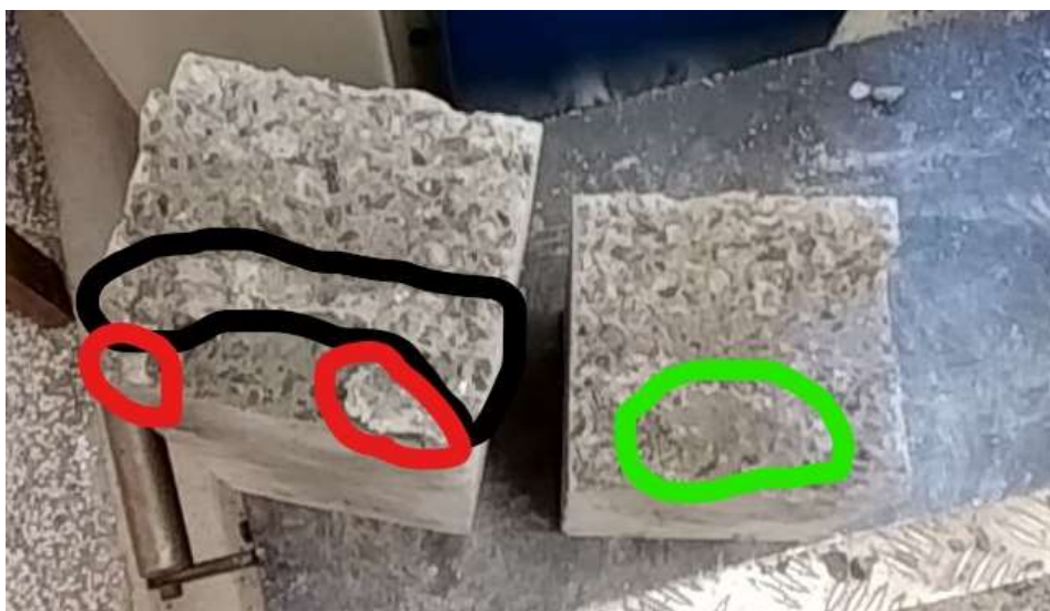
Figura 25 – Detalhe do corpo de prova 1 reparado com Hardfix
