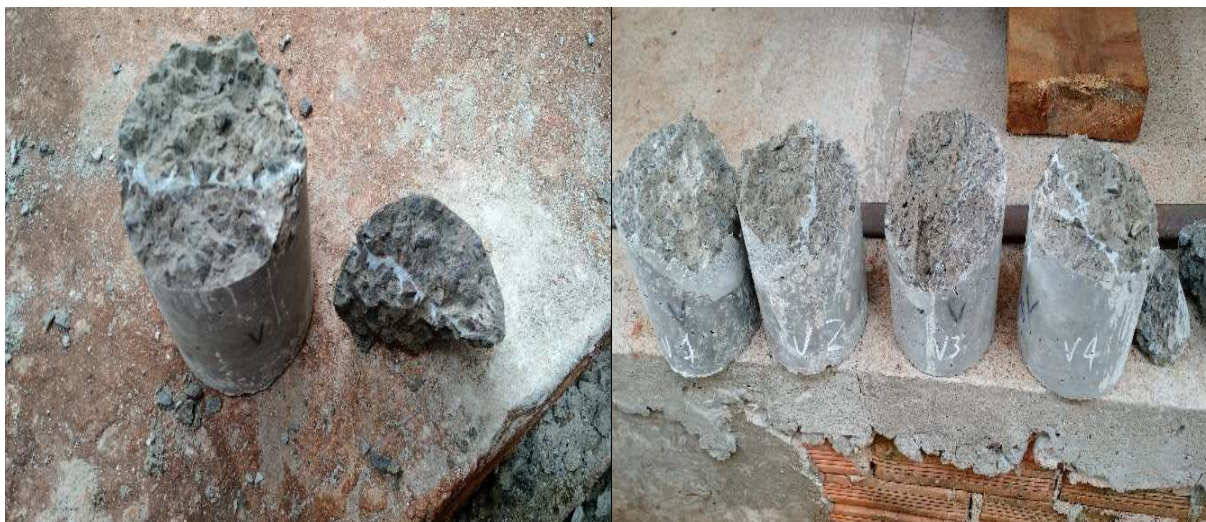
Figura 16 - Corte no corpo de prova mostrando a parte colada (Compound)
