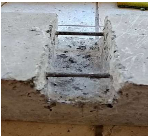
Figura 11 — Corpo de prova prismático com entalhe
