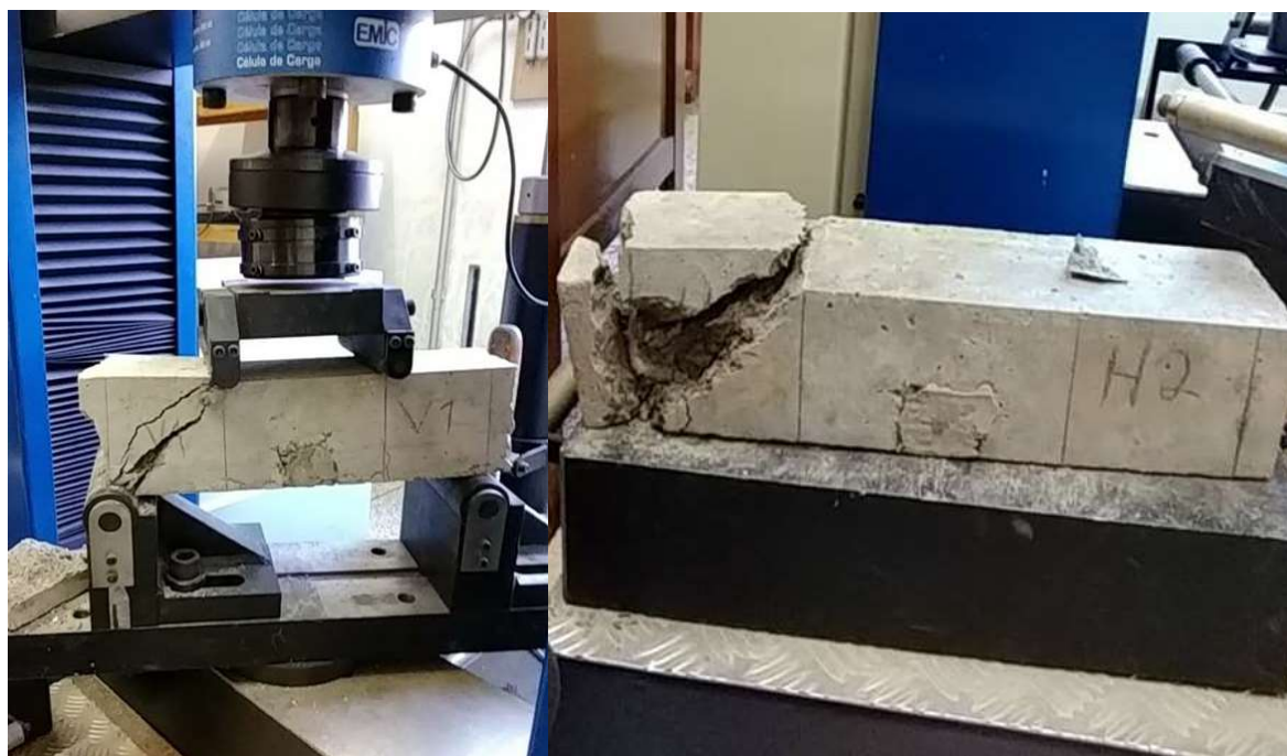
Figura 23 – Corpo de prova 1 recuperado com Compound e corpo de prova 2 recuperado com Hardfix com ruptura no apoio
