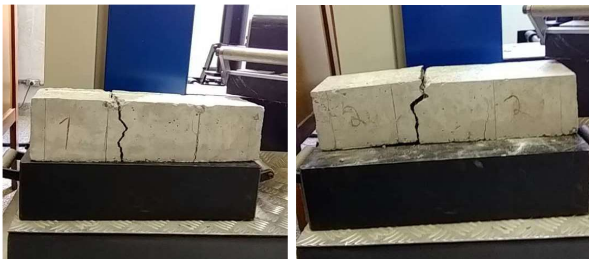
Figura 14 - Rompimento dos prismas sem defeito
