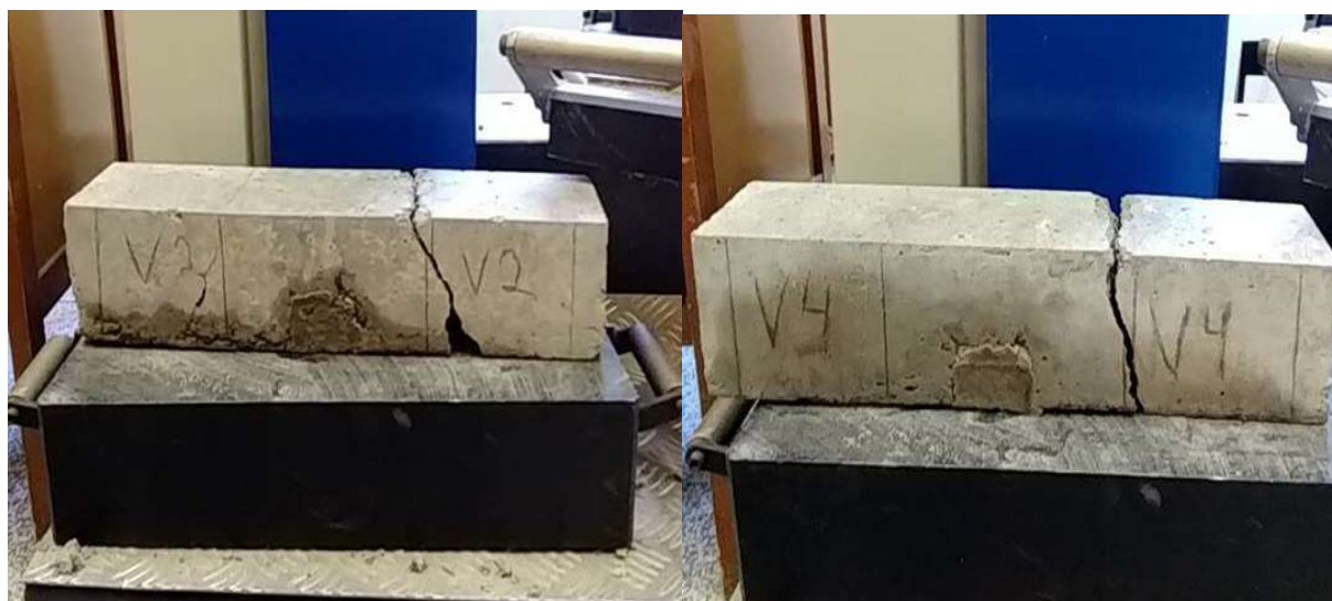
Figura 20 – Ruptura dos prismas recuperados com Compound
