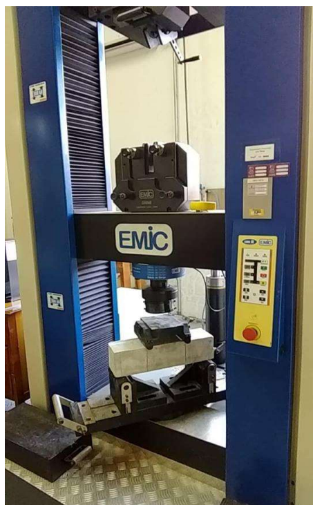
Figura 13 – Ensaio de resistência à tração na flexão a quatro pontos
