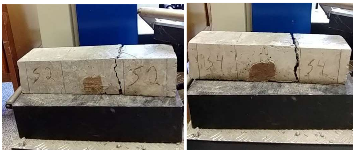
Figura 21 - Ruptura dos prismas recuperados com Sikadur 32
