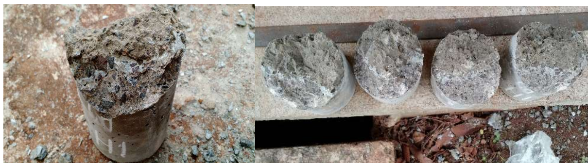
Figura 19 - Corte no corpo de prova mostrando a parte colada (Hardfix)
