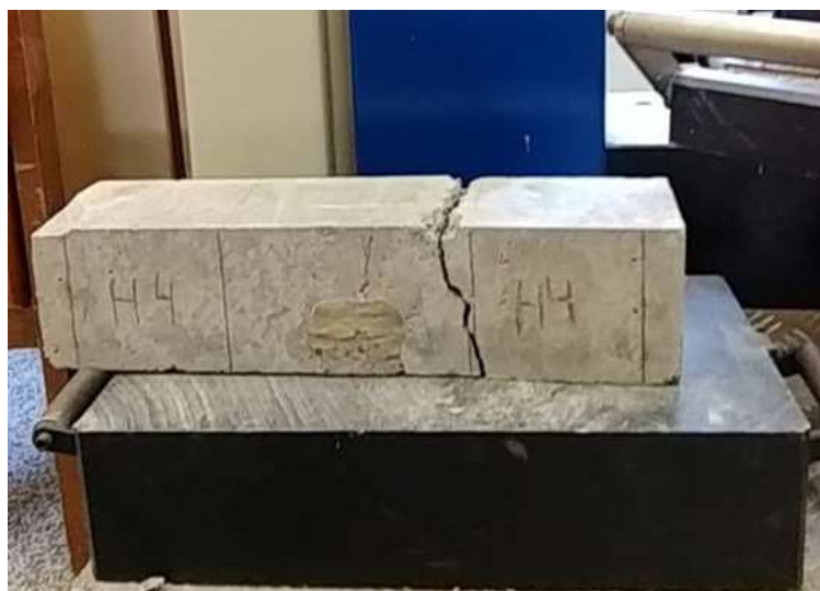
Figura 22 - Ruptura dos prismas recuperados com Hardfix
