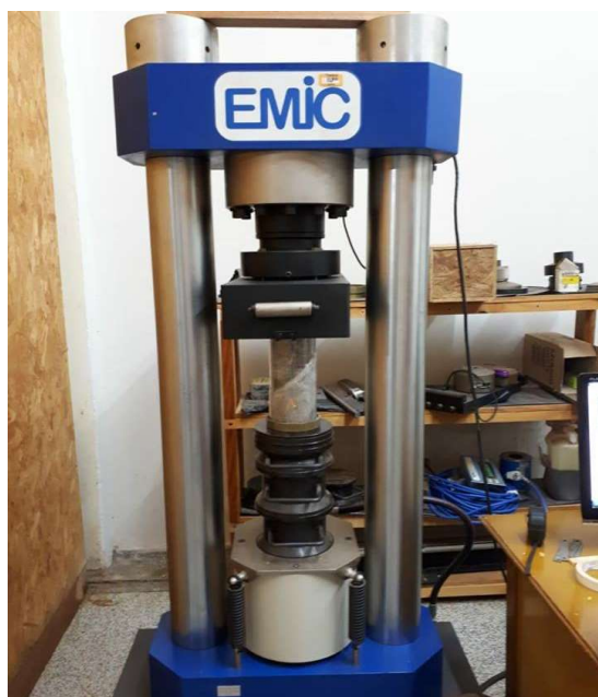
Figura 9 – Ensaio de resistência à compressão
