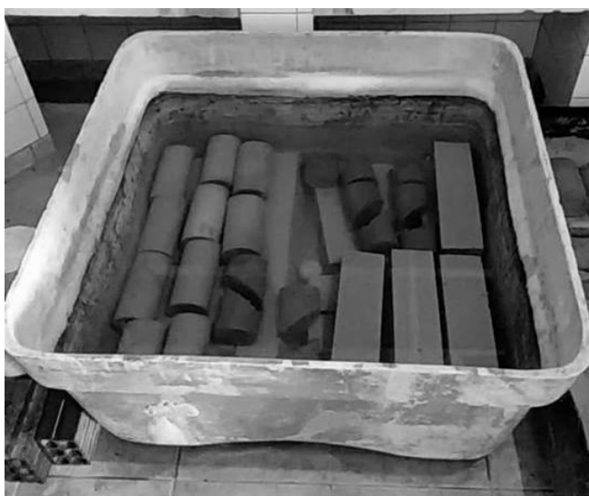
Figura 12 – Cura dos corpos de prova
