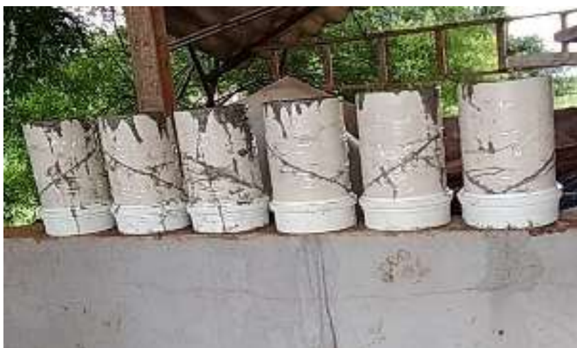
Figura 6 — Concretagem em cano PVC recuperado com fita adesiva
