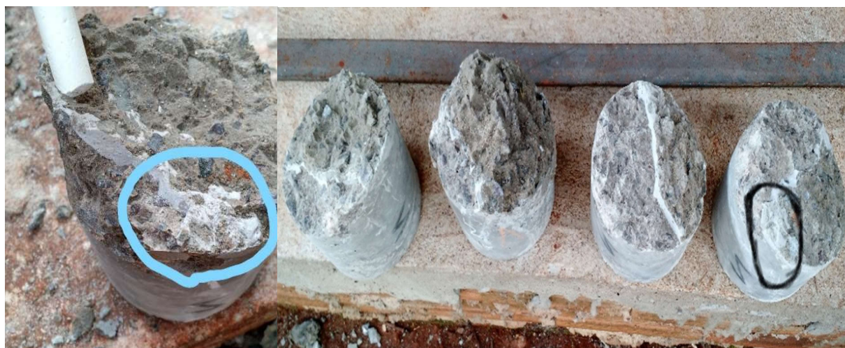
Figura 18 - Corte no corpo de prova mostrando a parte colada (Sikadur 32)
