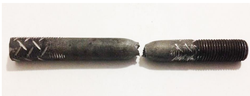
Figura 39 – Corpos de prova de tração no pino.
