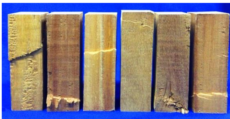
Figura 36 – Corpos de prova de compressão paralela Garapeira.
