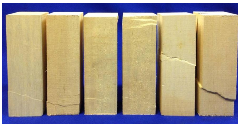
Figura 37 – Corpos de prova de compressão paralela Caixeta.
