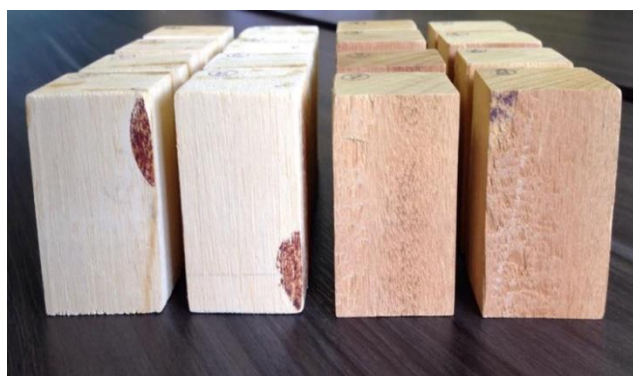
Figura 35 – Corpos de prova de umidade e densidade.
