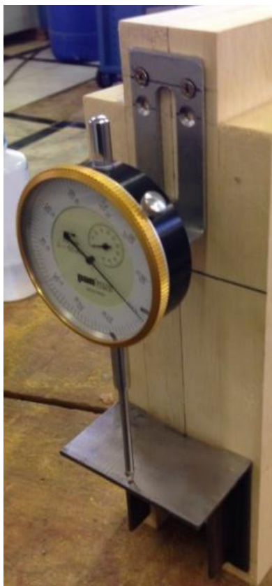
Figura 32 – Corpo de prova com relógios comparadores.
