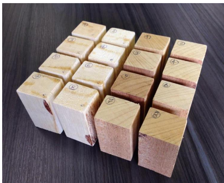
Figura 26 – Corpos de prova para determinação da umidade e densidade aparente
