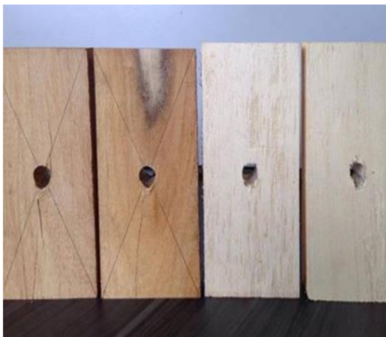
Figura 38 – Corpos de prova de embutimento
