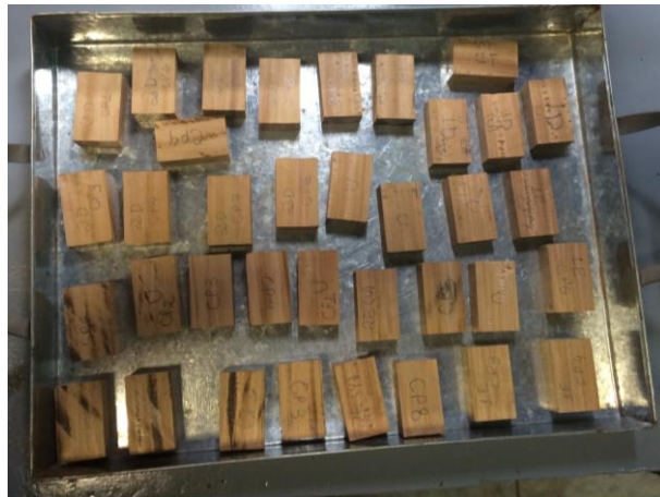
Figura 14 - Corpos de prova para ensaio de densidade e teor de umidade Fonte: O Autor
