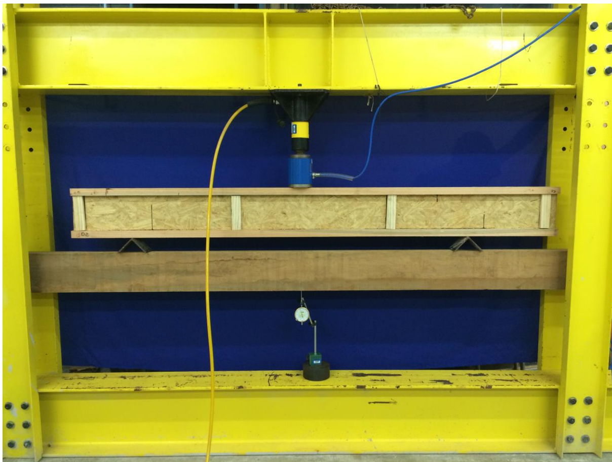
Figura 11 - Ensaio de flexão estática à quatro pontos
