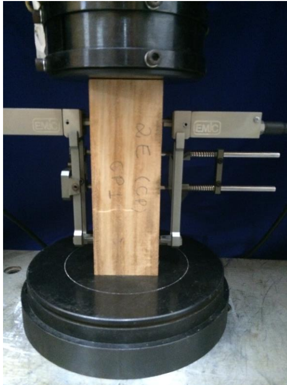
Figura 15 - Ensaio de compressão paralela às fibras Fonte: O Autor
