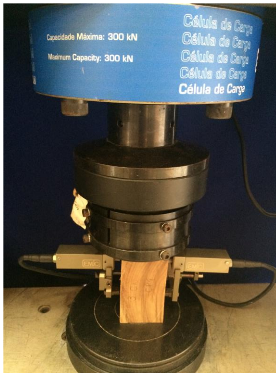
Figura 16 - Ensaio de compressão normal às fibras Fonte: O Autor
