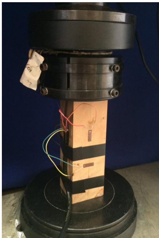
Figura 19 - Ensaio de compressão com as fibras inclinadas Fonte: O Autor
