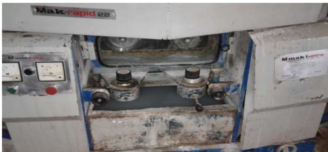
Figura 4 – Reservatório de água da lapidadora
