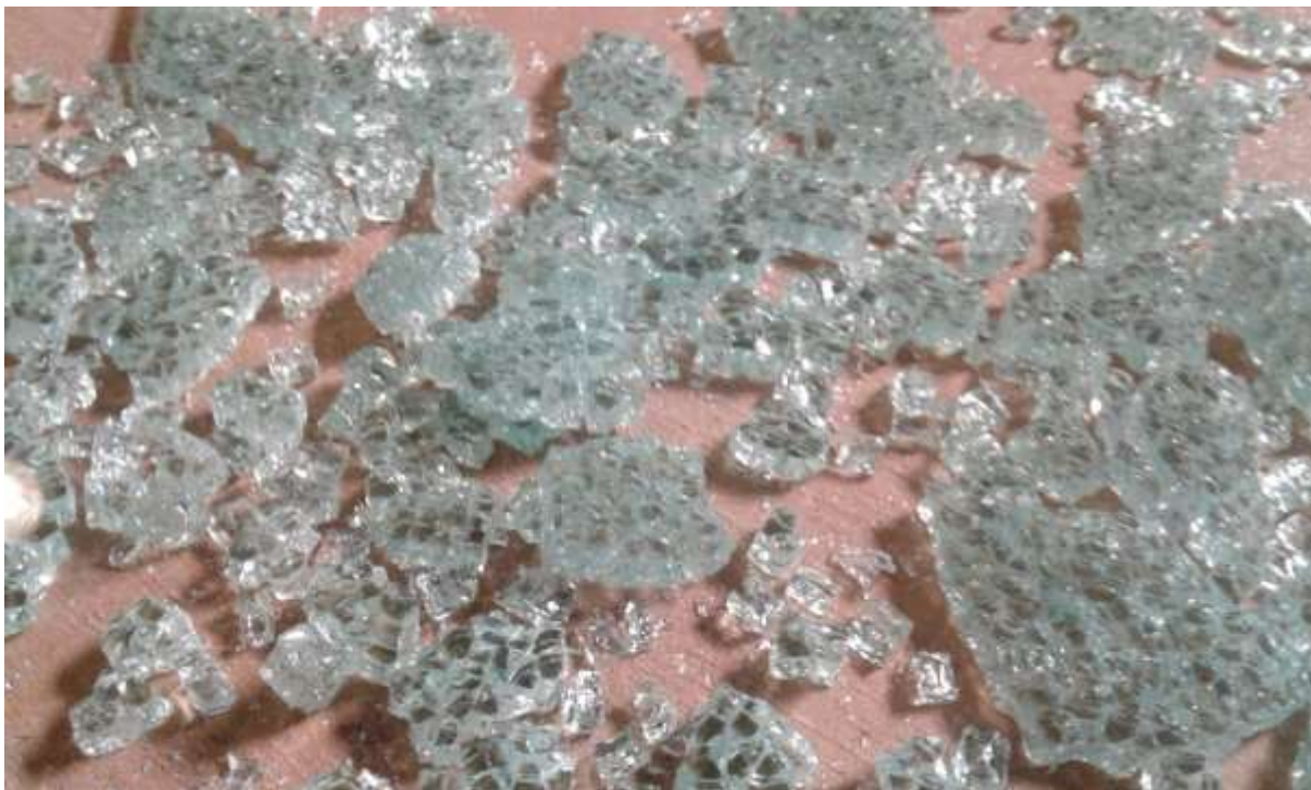
Figura 7 – Caco de vidro temperado – Forma de ruptura. Fonte: O Autor
