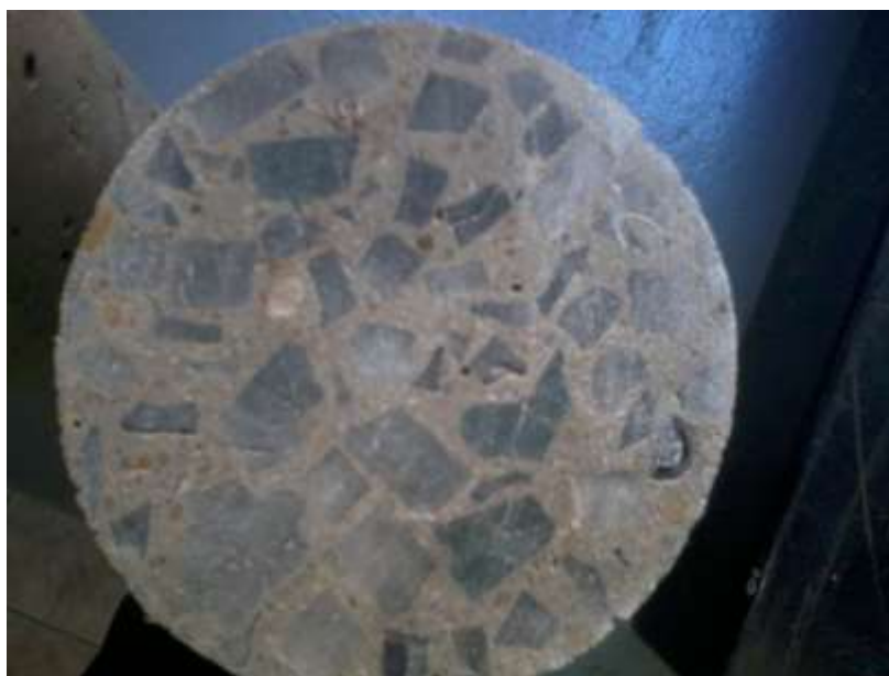
Figura 9 – Concreto seco, retificado, com 100% do agregado graúdo de vidro.
