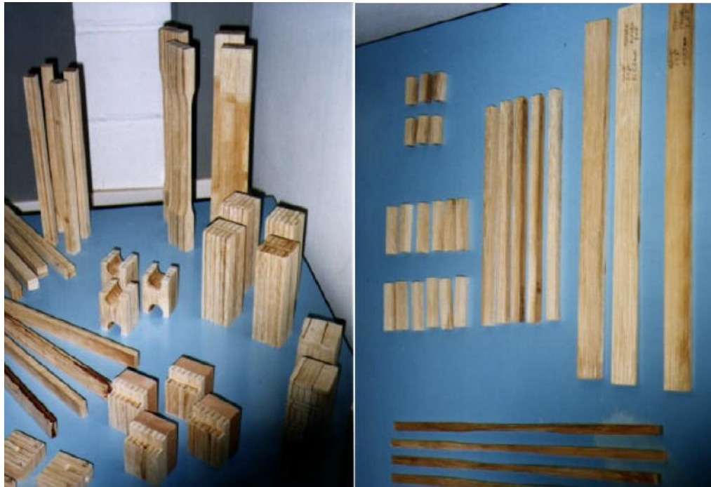
Figura 18 - Amostras de bambu para ensaio de resistência mecânica Fonte: Gonçalves (2000)
