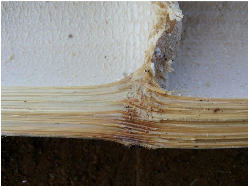
Figura 6 - Paralelismo das fibras do bambu
